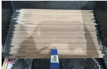
Figura 1. Colocación de electrodos en la canasta de alimentación.
