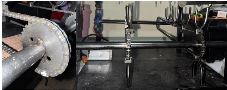
Figura 28. Sprockets y cadenas del sistema de recolección y almacenamiento.
