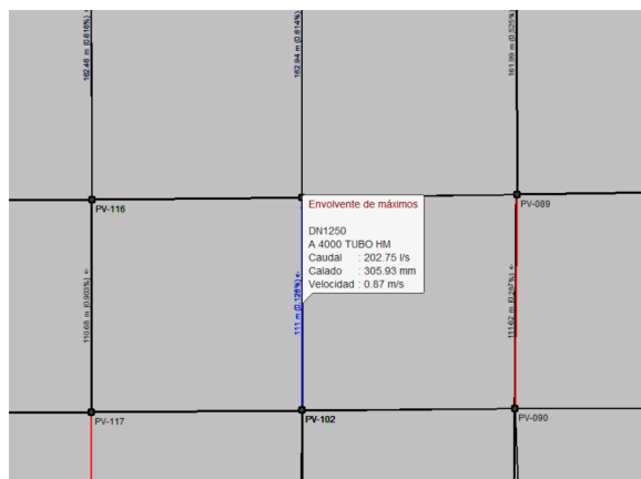
Figura 26: Información del elemento que no cumple con requisitos de diseño.
