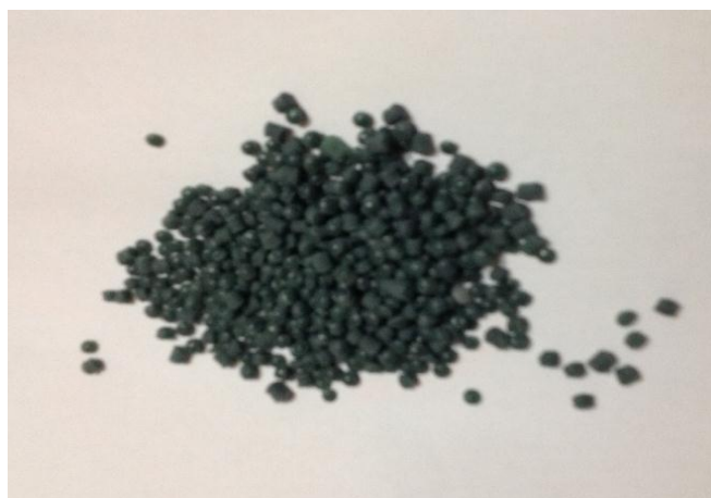
Figura No. 26: Aditivo de control de coeficiente de fricción obtenido de la granuladora de polietileno a partir del aditivo SLIP98%
