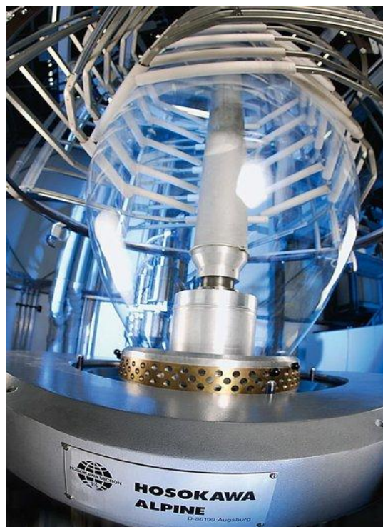
Figura No. 8: Burbuja formada en el proceso de extrusión de película soplada.
