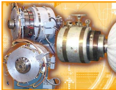
Figura No. 19: Dado anular utilizado en extrusión de película soplada.
