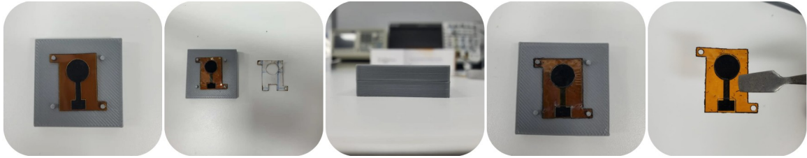
Figura 20. Proceso de aislamiento de electrodos LIG mediante sistema de alineamiento 3D. (1) Colocación del electrodo en la base de alineamiento; (2) aplicación de la capa de Kapton; (3) aplicación de presión uniforme por medio de la cubierta superior del sistema de alineamiento; (4) vista superior del aislamiento centrado; (5) electrodo final con recubrimiento íntegro
