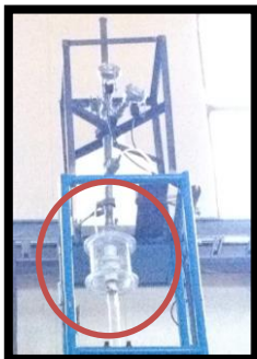
Figura No. 18 Distribuidor de líquido en la parte superior
