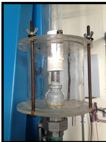
Figura No. 17 Distribuidor sección inferior torre
