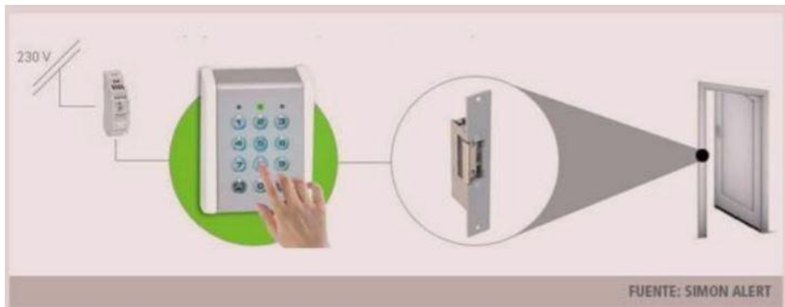
Figura 14. Ejemplo de cerradura eléctrica.
