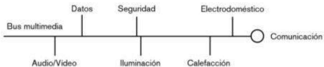
Figura 1. Definición teórica de Domótica mediante la disponibilidad de un bus doméstico multimedia. (Junestran Stefan, 2005)
