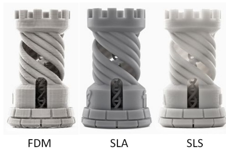
Figura 26: Ejemplos de impresión 3D en FDM, SLA y SLS [29]
