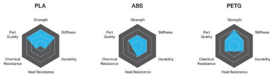
Figura 27: Propiedades físicas de los filamentos PLA, ABS y PETG [44]
