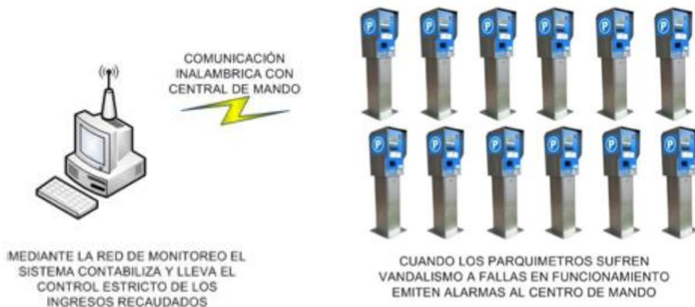
Figura 7: Alarma de equipo a central de monitoreo
