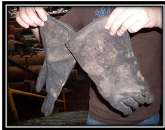
Ilustración 52 Estado del EPP utilizado y la falta de EPP.
