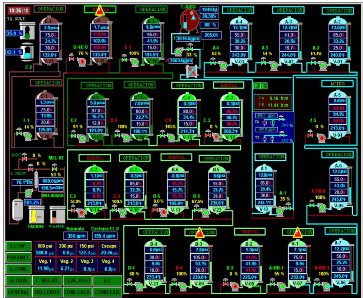
Ilustración 21 Pantalla de control de sistema de evaporación
