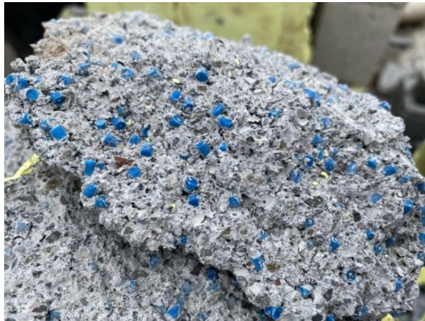
Figura 39. Distribución de las partículas de plástico de polietileno (PE) en la mezcla de concreto
