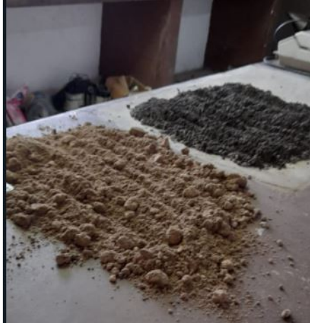
Figura 13. Agregados sobre superficie impermeable en estado seco saturado
