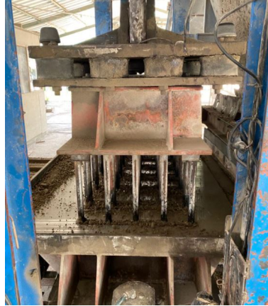
Figura 20. Proceso de vibro compactación de los bloques de concreto
