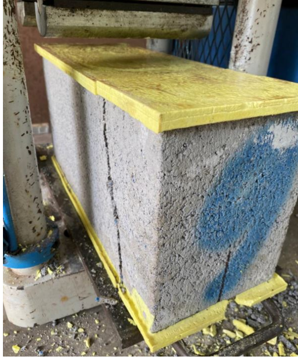
Figura 38. Falla por fractura cónica según NTG 41051 h2
