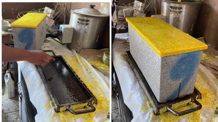
Figura 36. Cabeceo de las muestra de concreto antes de ensayo de resistencia a la compresión
