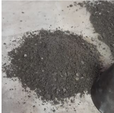
Figura 15. Muestra seca saturada después de compactación en cono metálico
