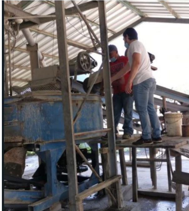
Figura 34. Verificación de humedad en mezcla de concreto dentro de mezcladora en el proceso de fabricación de los bloques de concreto
