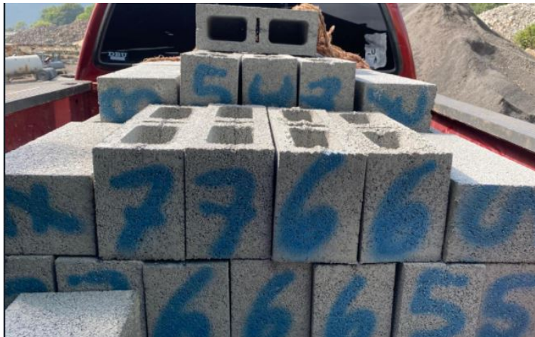
Figura 35. Transporte de muestras de bloques de concreto después de proceso de fabricación
