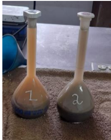
Figura 16. Probeta con muestra de agregados en agua
