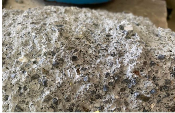
Figura 40. Distribución de las partículas de plástico de polipropileno (PP) en la mezcla de concreto
