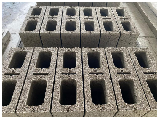
Figura 22. Bloques apilados en su etapa de fraguado
