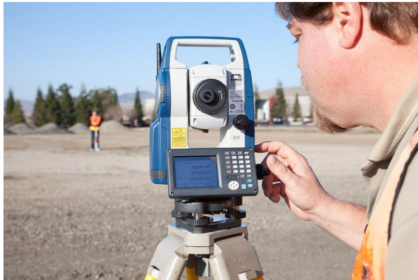
Figura 26. Uso de equipo topográfico para medir niveles
