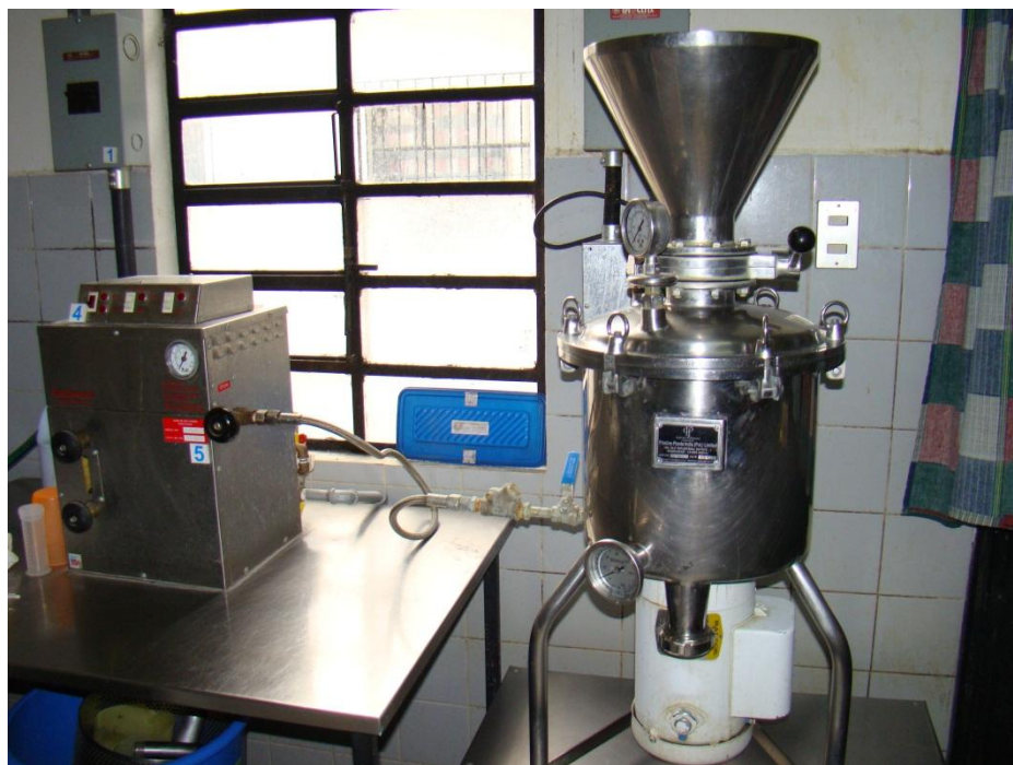
Fotografía No.16. Elaboración de leche de soya y maíz con la “Vaca Mecánica”
