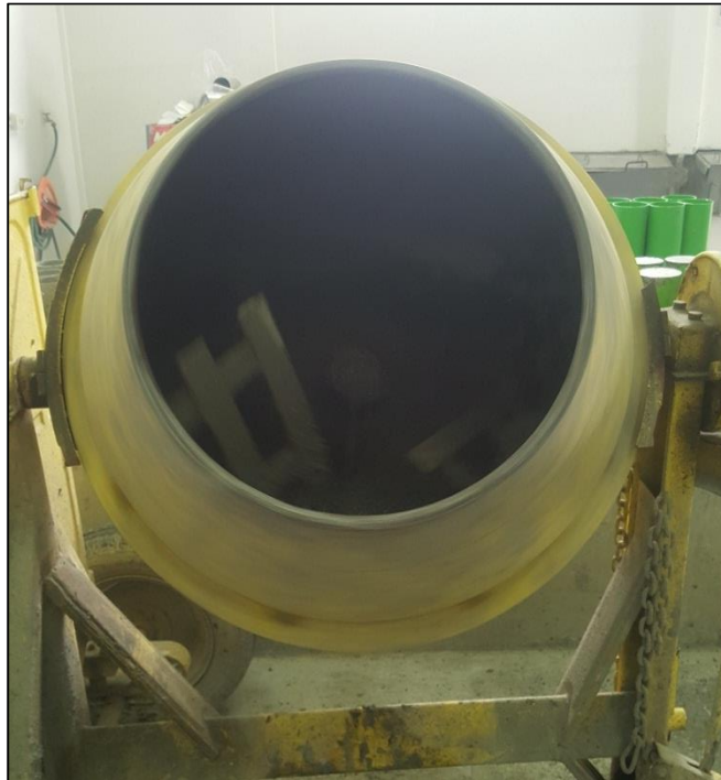
Gráfico 24: Elaboración de mezclas de prueba (0.045 m3)
