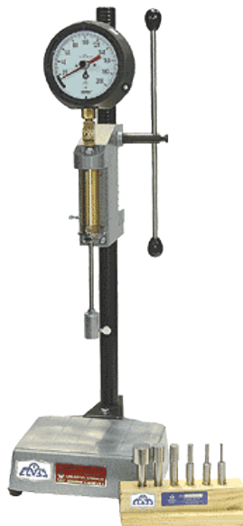
Gráfico 22: Ejemplo de penetrómetro
