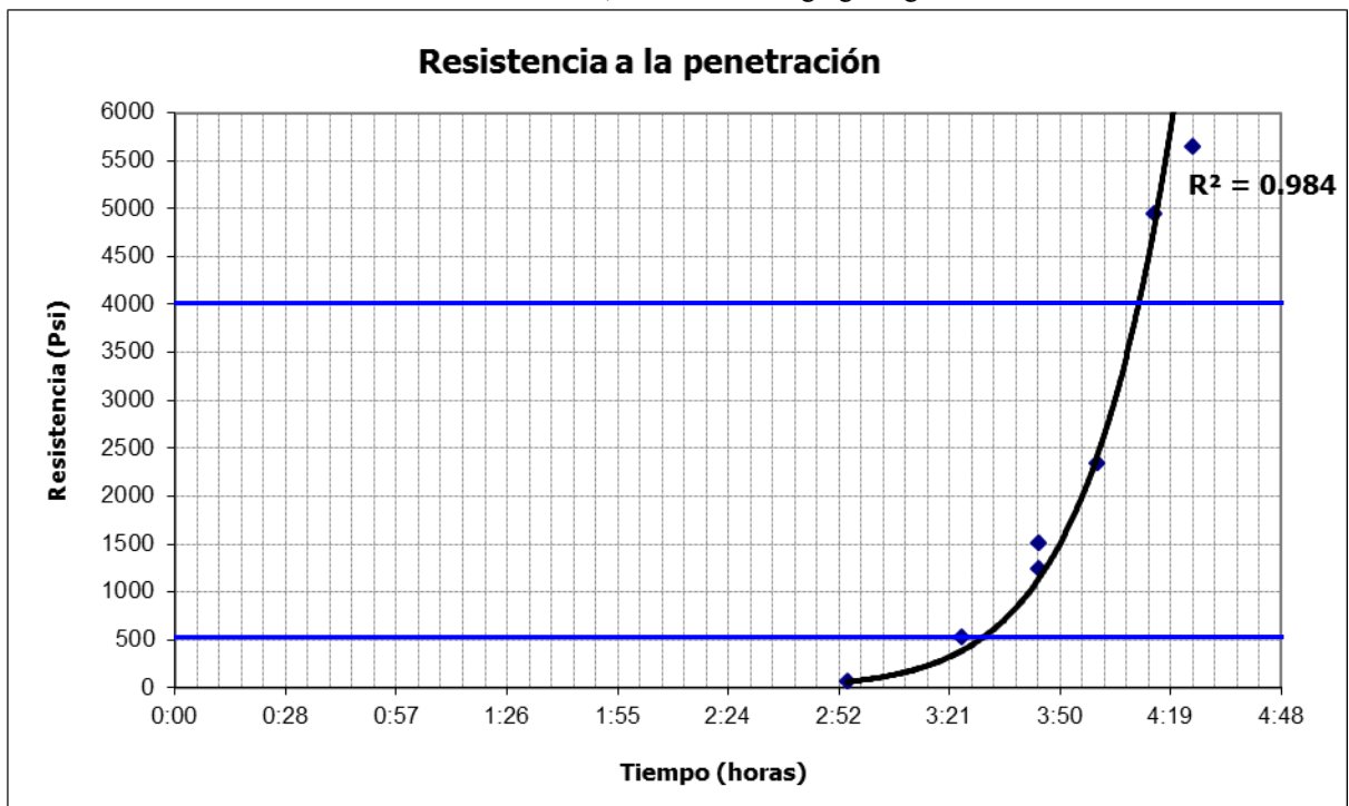
Gráfico 42: Gráfico del tiempo de fraguado por medio del penetrómetro para el concreto de 4000 PSI con tamaño máximo de 3/8", 4% menos de agregado grueso
