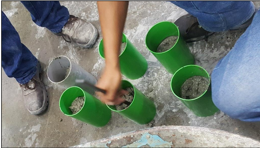
Gráfico 29: Cilindros para prueba de concreto endurecido
