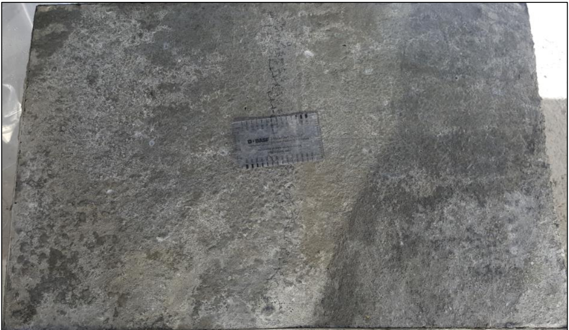
Gráfico 40: Fisura en muestra de concreto 4000 PSI tamaño máximo 3/4", 4% más de agregado grueso
