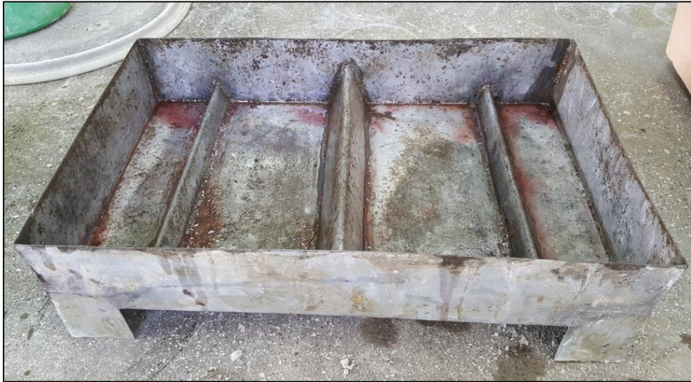
Gráfico 31: Molde para fabricación de especímenes de prueba.
