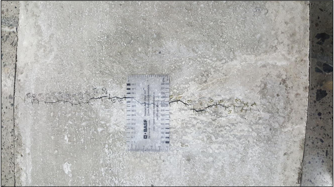
Gráfico 36: Fisura en muestra de concreto 4000 PSI tamaño máximo de 3/8", 4% menos de agregado grueso
