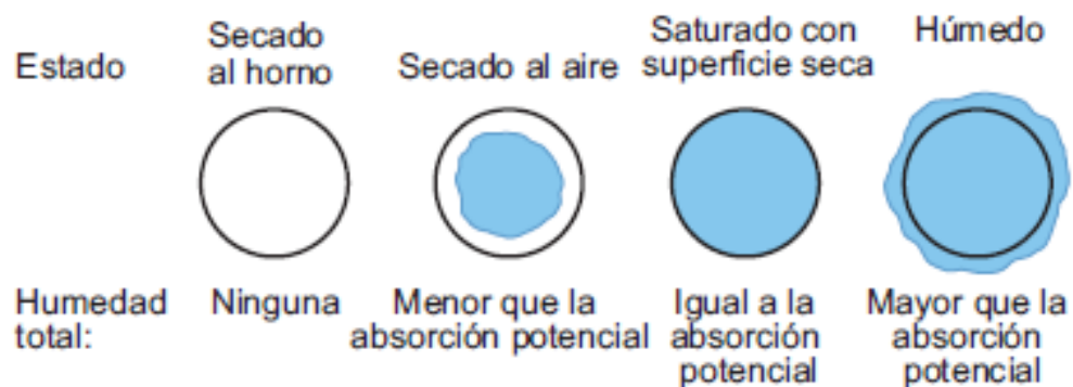
Gráfico 5: Cantidad de agua presente en los vacíos del agregado
