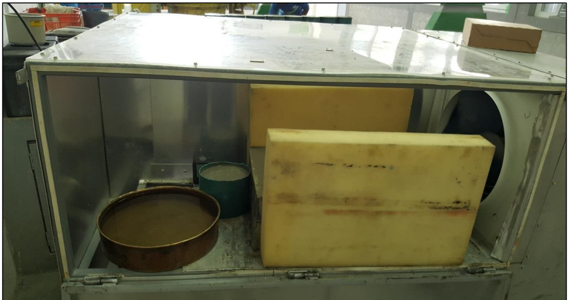
Gráfico 32: Pruebas en túnel de viento (temperatura, humedad, velocidad del viento, tasa de evaporación y fraguado)
