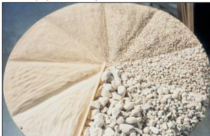
Gráfico 3: Agregado utilizado para concreto, con diferentes tamaños
