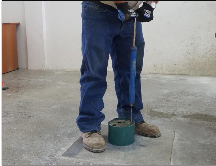
Gráfico 33: Prueba de penetrómetro para determinar el tiempo de fraguado
