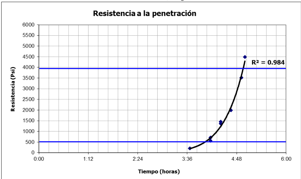
Gráfico 44: Gráfico del tiempo de fraguado por medio del penetrómetro para el concreto de 4000 PSI con tamaño máximo de 3/4", testigo
