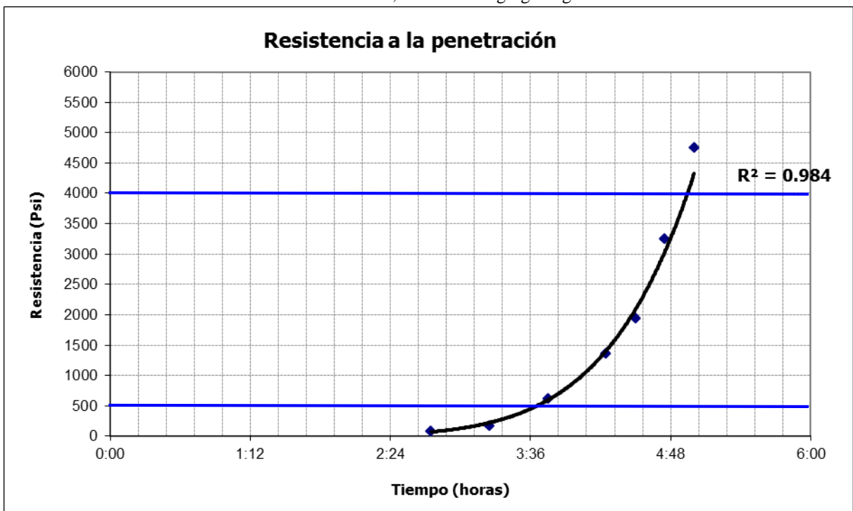
Gráfico 46: Gráfico del tiempo de fraguado por medio del penetrómetro para el concreto de 4000 PSI con tamaño máximo de 3/4", 4% más de agregado grueso
