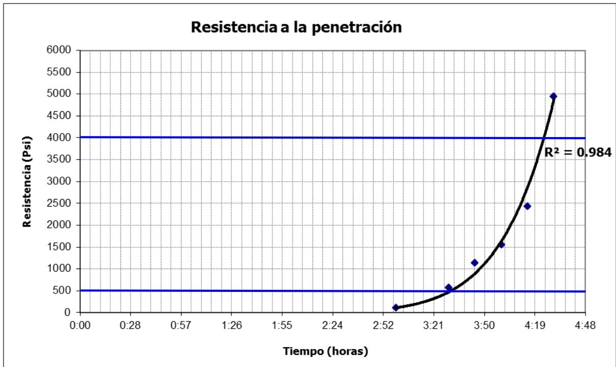
Gráfico 43: Gráfico del tiempo de fraguado por medio del penetrómetro para el concreto de 4000 PSI con tamaño máximo de 3/8", 4% más de agregado grueso
