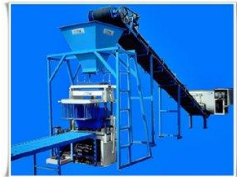
Imagen 7. Banda transportadora en elevación.
