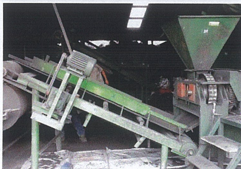
Figura 8. Máquina de compactación (Briquetera)
