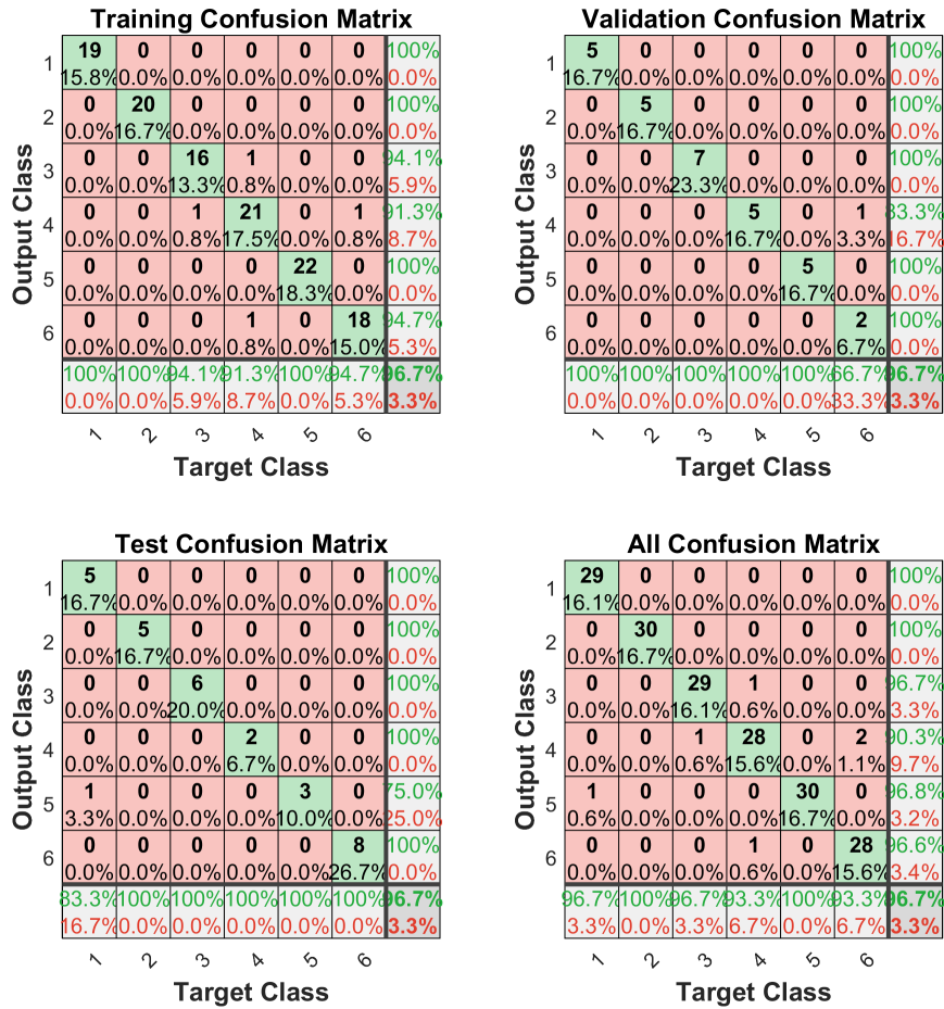
Figura 43: Resultados obtenidos con RN para clasificación de 6 clases, 7 características. Sujeto 1: female_1.mat .
