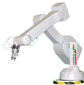
Figura 64: Manipulador serial R17 de 5 GDL más carrera [27].
