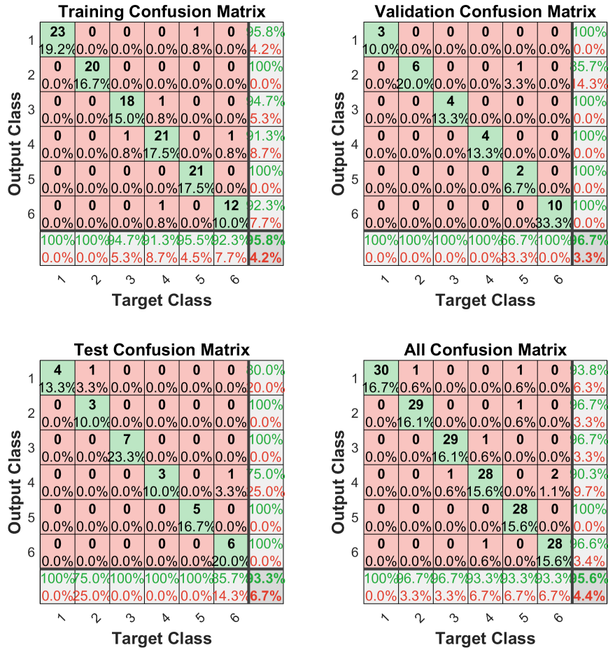
Figura 39: Resultados obtenidos con RN para clasificación de 6 clases, 3 características. Sujeto 1: female_1.mat .
