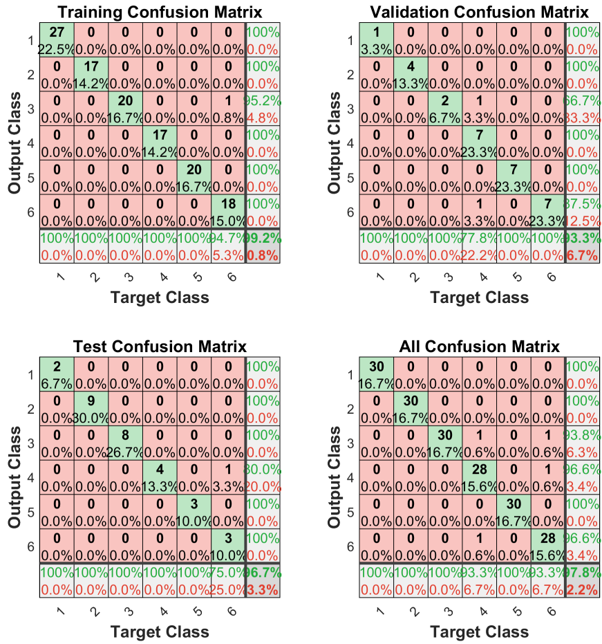
Figura 93: Resultados obtenidos con RN para clasificación de 6 clases, 3 características. Sujeto 2: female_2.mat .
