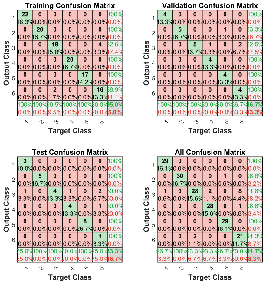
Figura 100: Resultados obtenidos con RN para clasificación de 6 clases, 7 características. Sujeto 3: female_3.mat .
