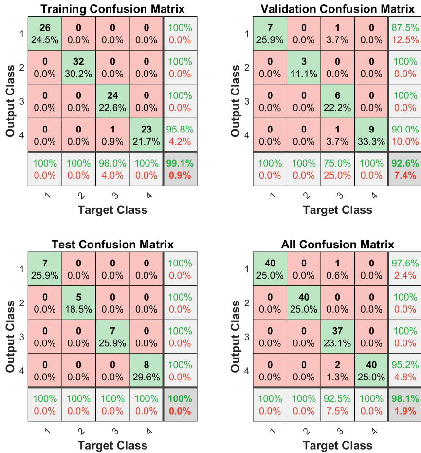
Figura 63: Resultados con RN para clasificación de 4 clases con 4 características (MAV,ZC,WL y RMS).
