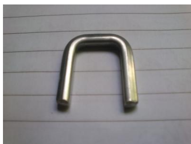
Imagen No. 18 – Grapas industriales para el cerrado de las bolsas
