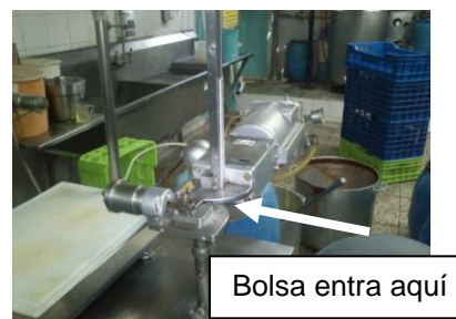
Imagen No. 19 – Engrapadora neumática industrial
