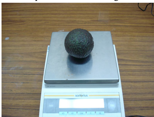
Fig. 2. Balanza digital utilizada para medir el peso fresco de los aguacates.
