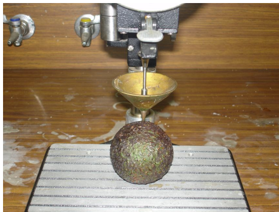
Fig.5. Penetrómetro utilizado para medir dureza
