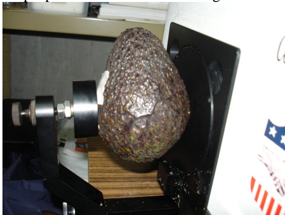
Fig. 7. Colorímetro utilizado para medir las propiedades del color de los aguacates
