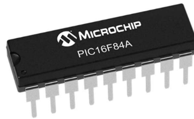
Figura 16. Presentación PDIP de un microcontrolador PIC16F84A.
