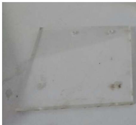
Figura 134. Base para el Arduino Uno en acrílico.
