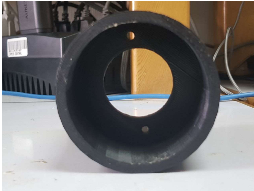
Figura 187. Vista superior del modelo de la parte alta del antebrazo fabricado en PLA mediante impresión en 3D.
