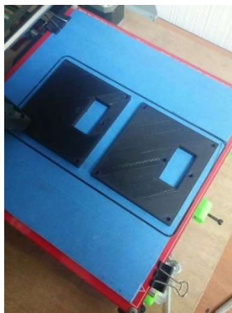
Figura 110. Impresión en 3D de la segunda versión del case.
