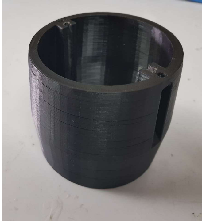
Figura 189. Modelo de la parte baja del antebrazo fabricado en PLA mediante impresión en 3D.
