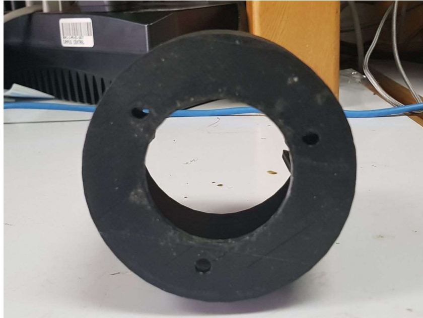
Figura 191. Vista inferior del modelo de la parte baja del antebrazo fabricado en PLA mediante impresión en 3D.
