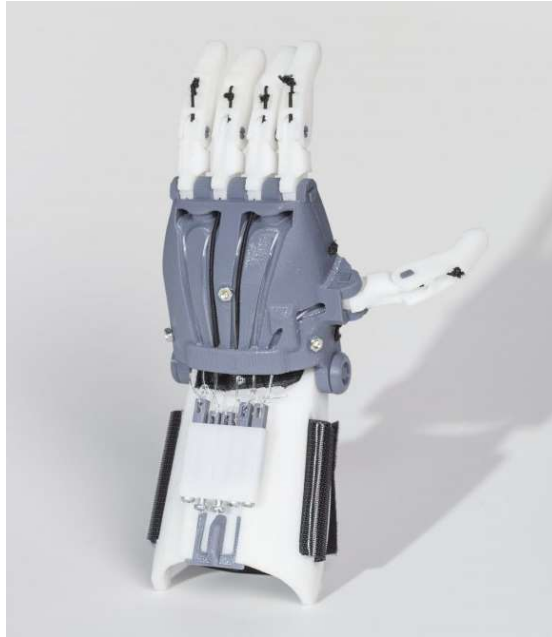
Figura 143. Prótesis biomecánica moderna fabricada con una impresora 3D.
