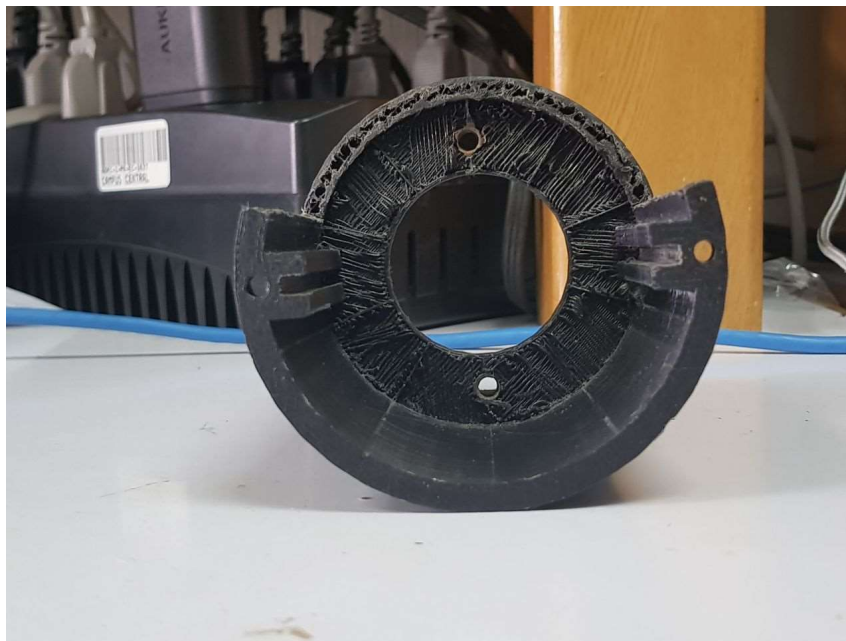
Figura 188. Vista inferior del modelo de la parte alta del antebrazo fabricado en PLA mediante impresión en 3D.
