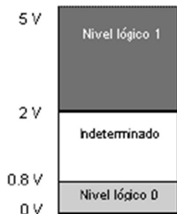
Figura 20. Rango de voltajes según lógica TTL.
