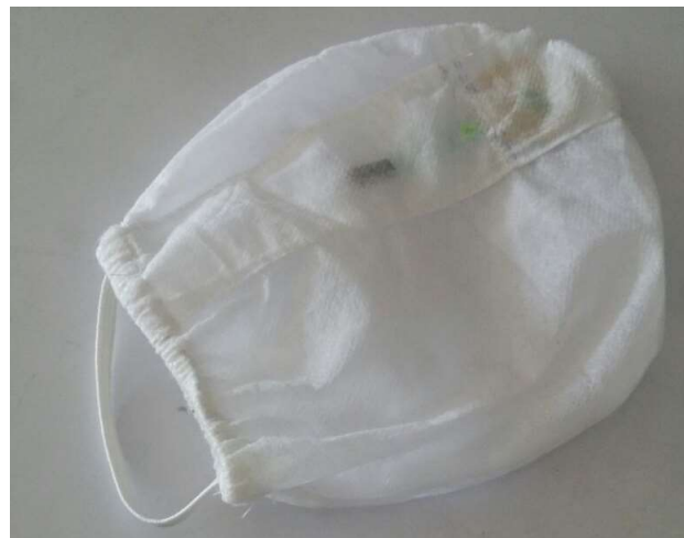
Figura 106. Plantilla después de haberla cosido y con el sensor dentro de su alojamiento.
