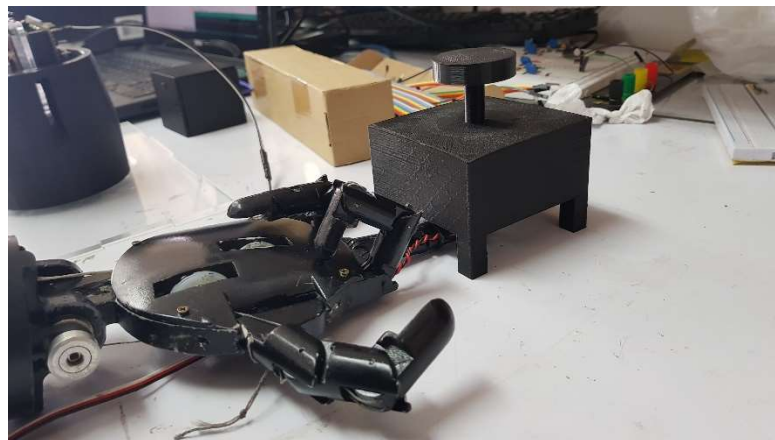
Figura 168. Base impresa en 3D para distribuir pesos sobre el sensor.
