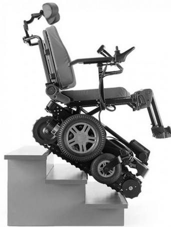
Figura 94. Silla de ruedas TopChair-S capaz de subir y bajar gradas
