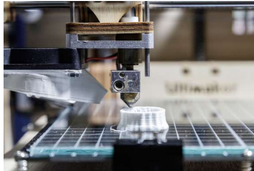
Figura 7. Proceso aditivo utilizando una impresora 3D.
