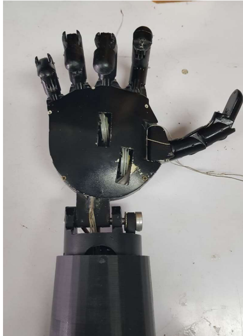
Figura 199. Prueba de la posición 2, agarre cilíndrico.
