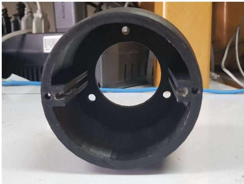
Figura 190. Vista superior del modelo de la parte baja del antebrazo fabricado en PLA mediante impresión en 3D.
