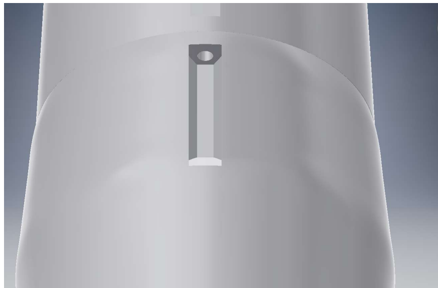
Figura 166. Ampliación del punto de conexión en la sección baja del antebrazo.
