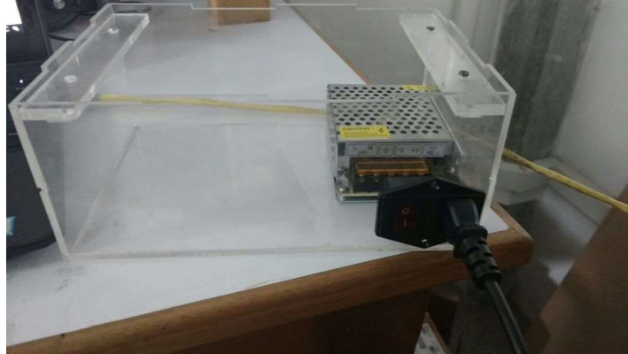
Figura 137. Fuente de alimentación colocada en su contenedor.
