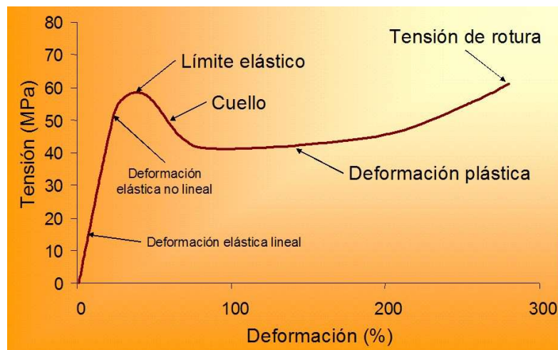
Figura 5. Curvatura esfuerzo-deformación para un polímero.
