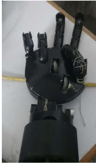
Figura 133. Ensamblaje entre mano y muñeca después de haberse pintado.
