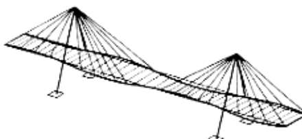
3. Sistema con torres en forma de A.
