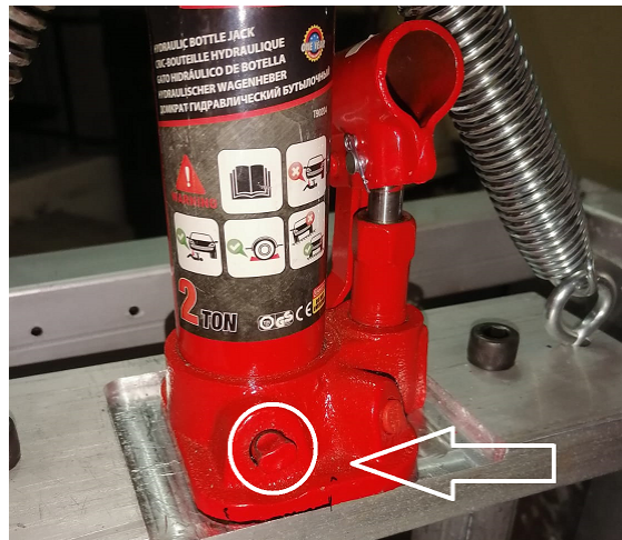
Figura 12. Válvula de alivio de gato hidráulico
