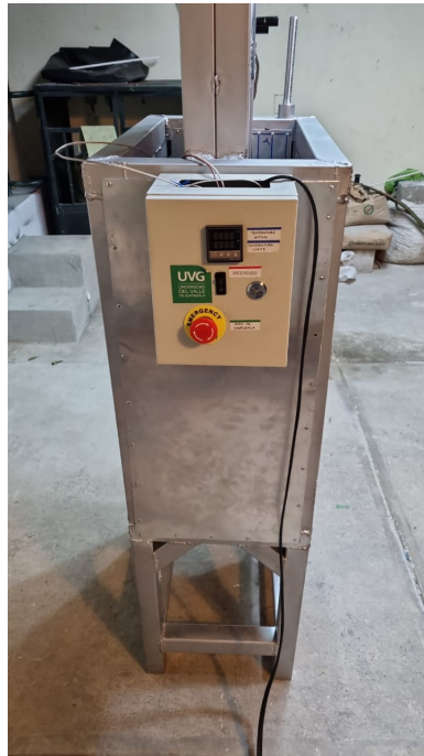
Figura 44: Sistema eléctrico ensamblado en compactadora
