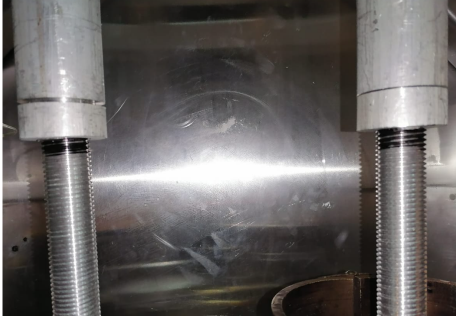
Figura 14. Marcas en la rosca de las extensiones
