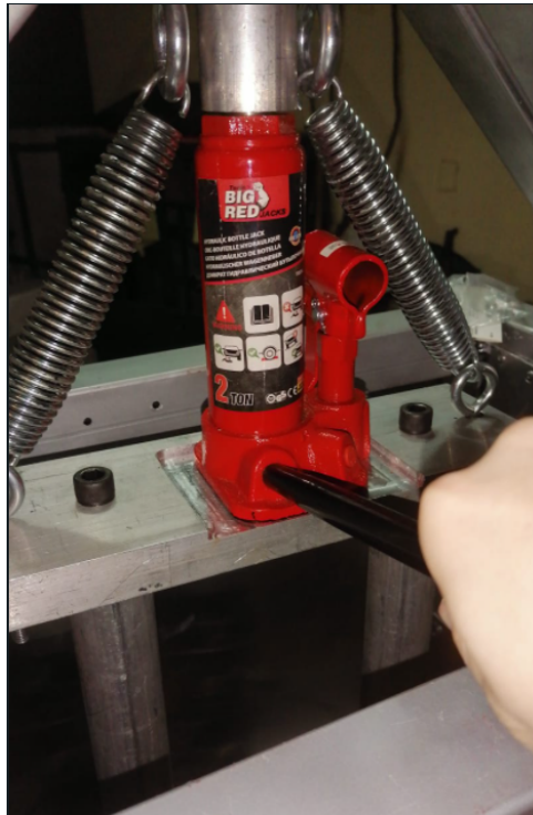
Figura 10. Liberación de la válvula de alivio del gato hidráulico
