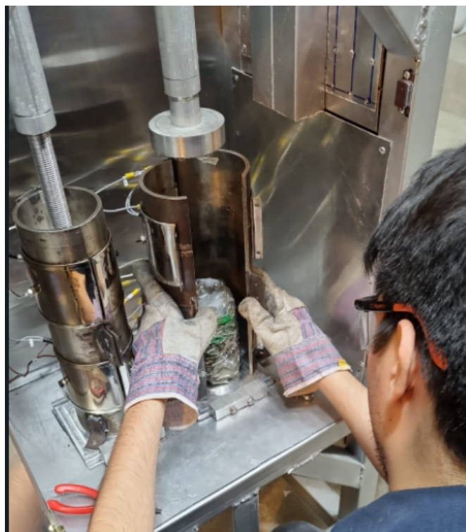
Figura 14. Separación de molde para retiro de plástico
