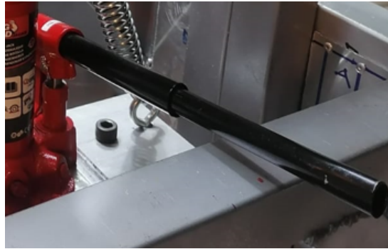
Figura 12. Sistema de bombeo del gato hidráulico
