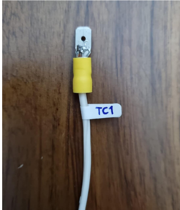
Figura 28: Ejemplo de etiquetado de terminales
