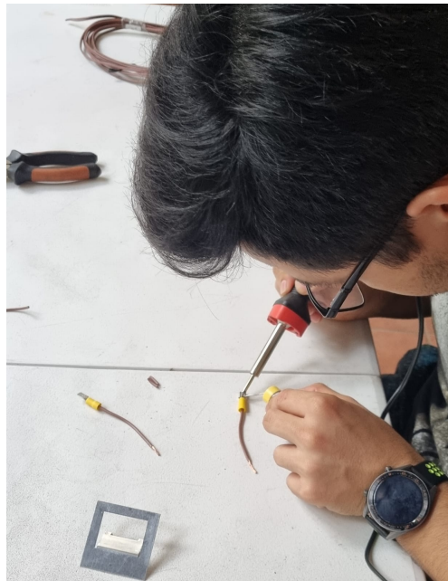
Figura 27: Proceso de soldadura de terminales a cables
