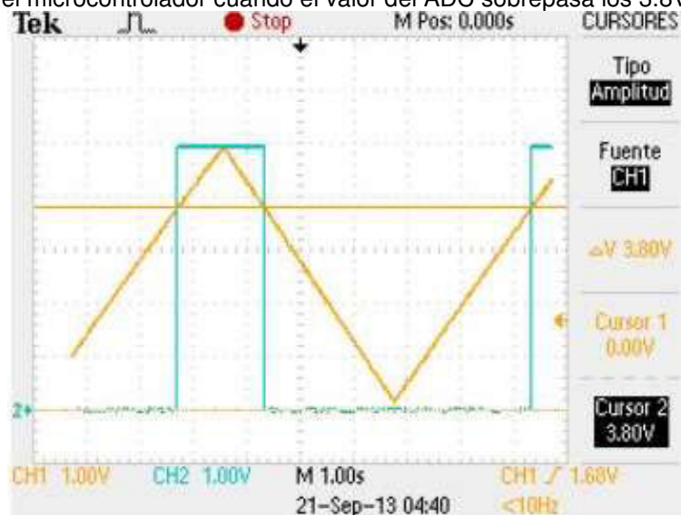
Figura 184. Generación de señal de inicio utilizando como entrada una señal triangular con voltaje de 0 a 5V. En amarillo se muestra la señal de entrada al canal ADC y en azul la señal generada por el microcontrolador cuando el valor del ADC sobrepasa los 3.8V.
