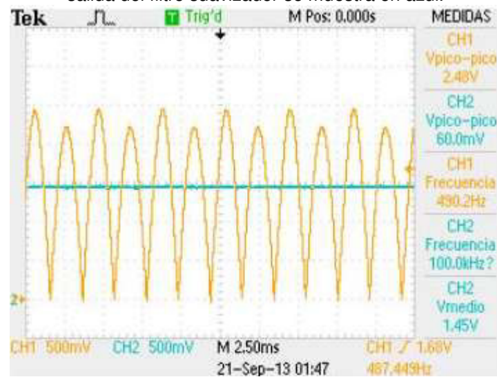
Figura 158. Filtro suavizador: En amarillo se muestra la señal de salida del circuito rectificador. La salida del filtro suavizador se muestra en azul.
