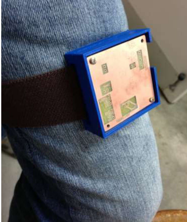
Figura 177. Uso de estuche porta placa para sostener el circuito de las extremidades anteriores.
