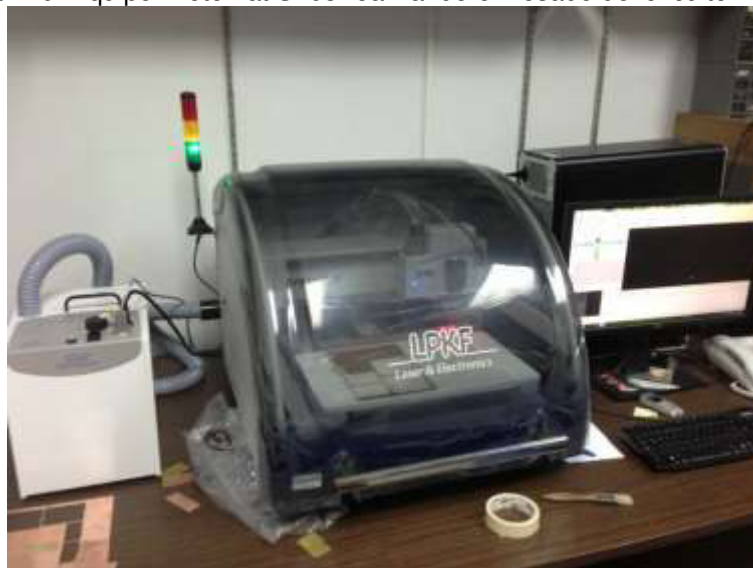
Figura 170. Equipo Protomat S103 realizando el fresado del circuito impreso.
