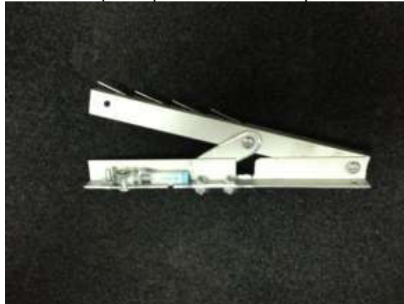
Figura 212. Primer prototipo construido con perfiles de aluminio.
