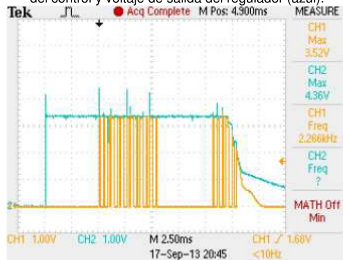
Figura 206. Señal transmitida por el circuito transmisor (amarillo) cada vez que se da una pulsación del control y voltaje de salida del regulador (azul).
