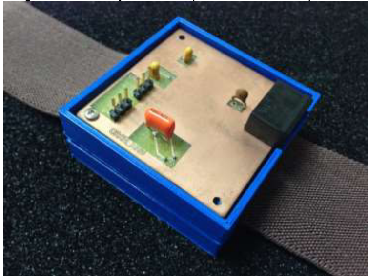
Figura 176. Montaje final de la placa en el estuche portador.
