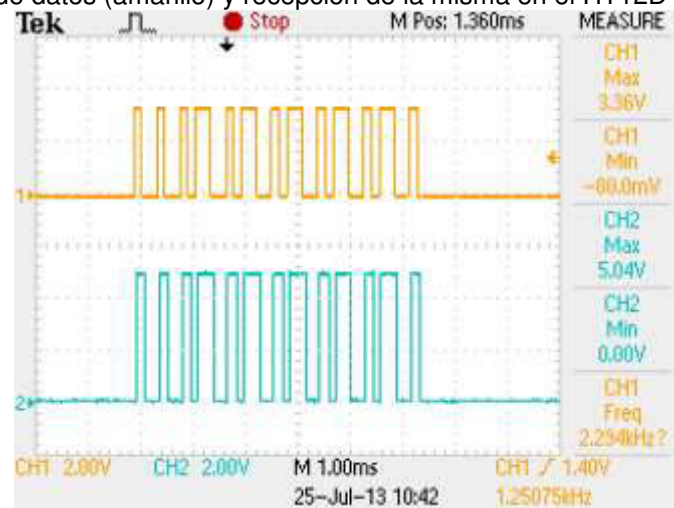
Figura 207. Trama serial que arma el codificador HT12E con los ocho bits de dirección y los cuatro bits de datos (amarillo) y recepción de la misma en el HT12D (azul).
