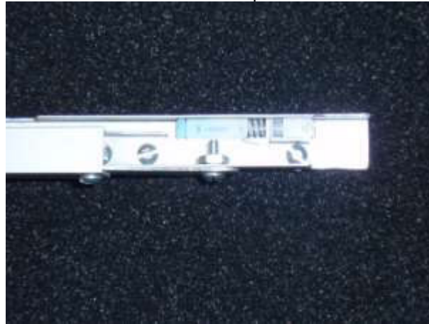
Figura 216. Vista de la ubicación del chispero en el sistema de activación.
