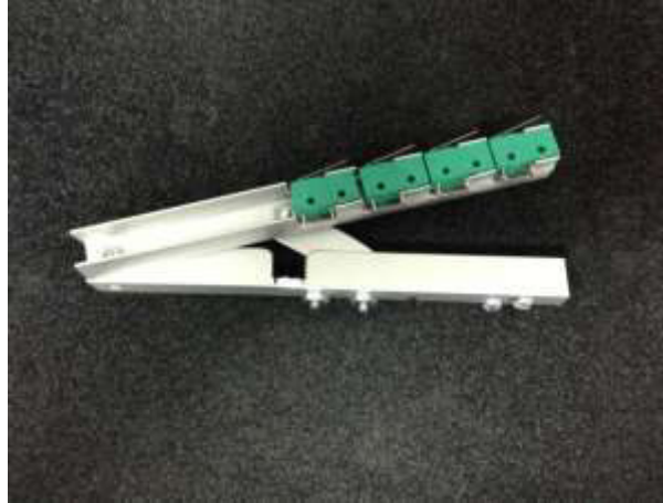
Figura 213. Vista de los botones incorporados al primer diseño en aluminio.
