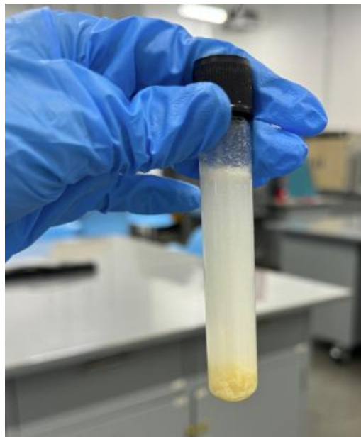
Imagen 38. Dilución de galletas con biomasa de Bacillus subtilis (ATCC11774), horneadas, para su análisis
