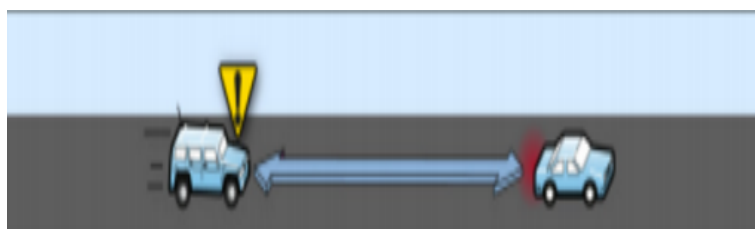
FIGURA 4.10: Ejemplo de advertencia de colisión al frente del vehículo. (Harding et al. , 2014)
