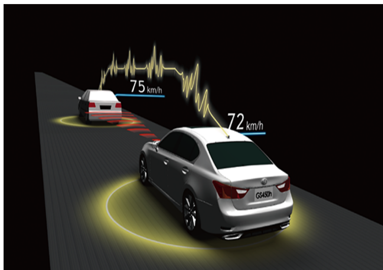
FIGURA 4.8: Cada vehículo le envía información importante a otros como por ejemplo la velocidad. Toyota (2014)
