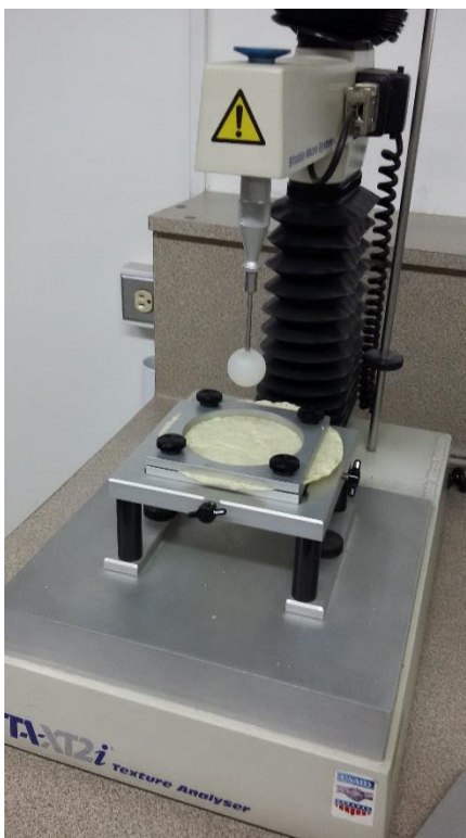
Figura 13. Prueba de evaluación de tensión de la tortilla
