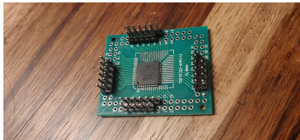
Figura 17: PIC 18F47J13 soldado en un adaptador TQFP a DIP
