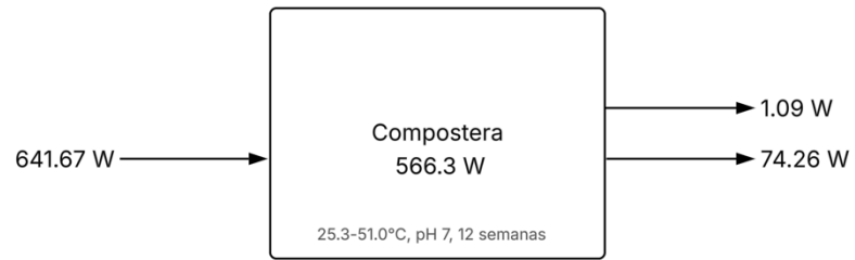
Figura 23. Balance de energía de la compostera para el compost con estiércol de vaca
