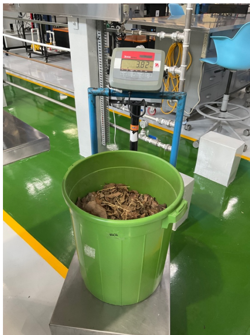
Figura 24. Masa inicial de la mezcla de abono orgánico con estiércol de vaca previo a ser triturado
