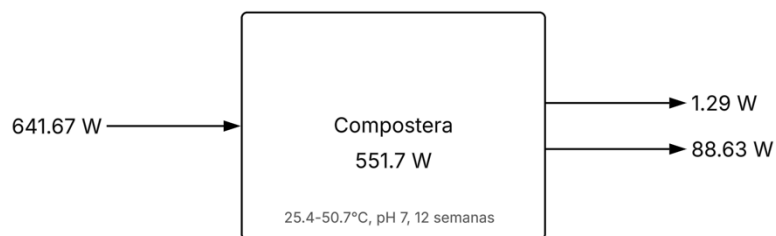
Figura 22. Balance de energía de la compostera para el compost con estiércol de caballo
