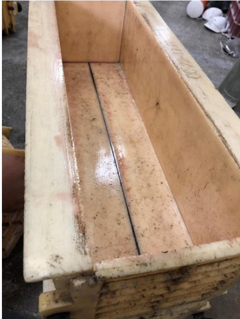
Fig. 30. Molde de la viga engrasado
