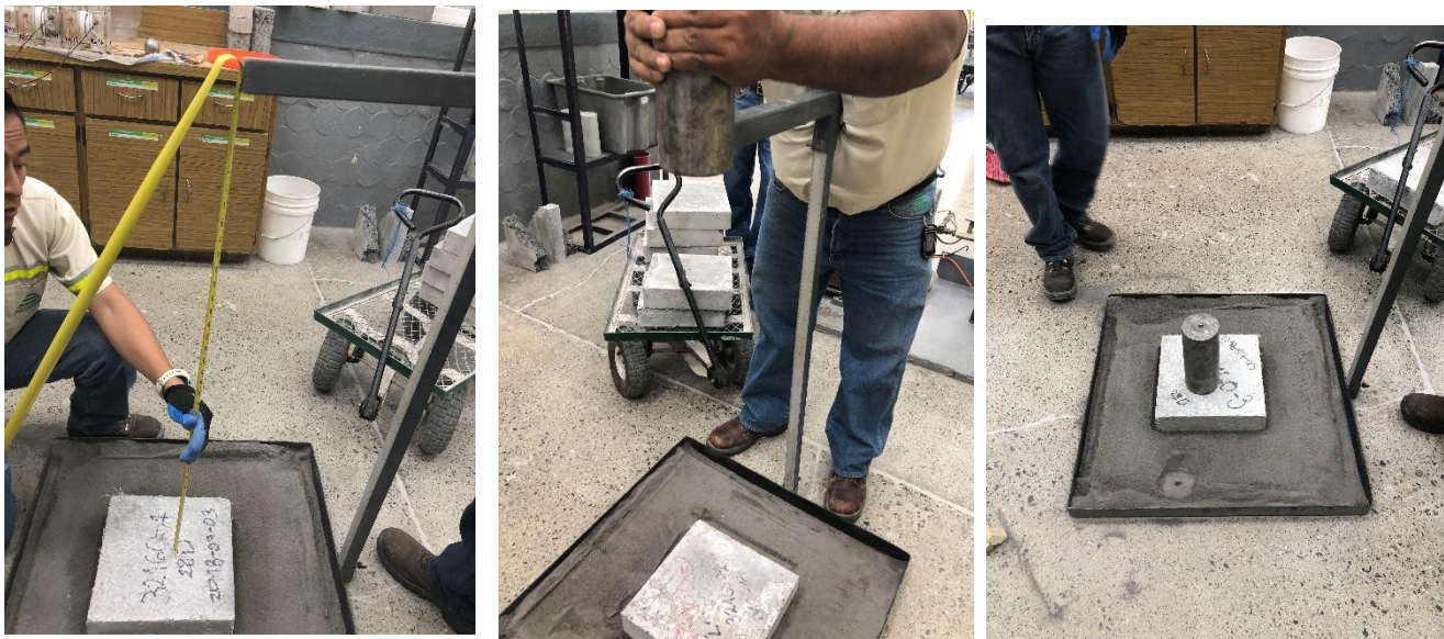
Fig. 52. Elaboración del ensayo de resistencia al impacto
