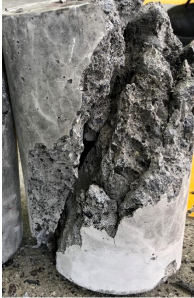
Fig. 50. Cilindro de la mezcla control ensayado a compresión
