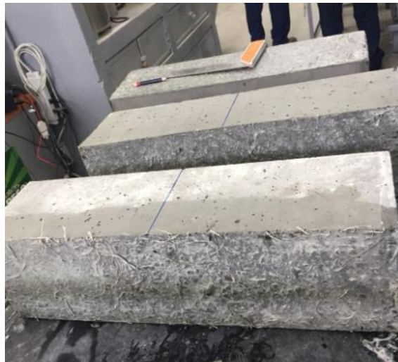
Fig. 16. Trazo de las vigas
