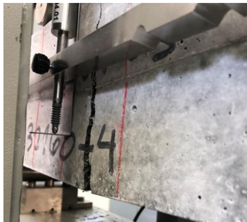
Fig. 37. Ensayo de tenacidad para viga con dosificación de seis kg/m 3
