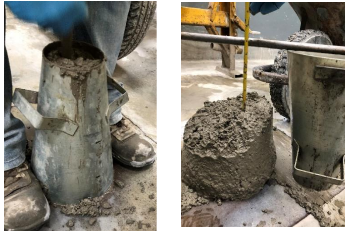
Fig. 26. Ensayo de asentamiento
