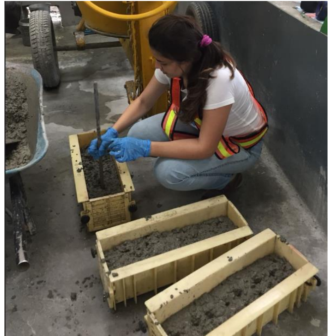
Fig. 32. Varillado de las vigas
