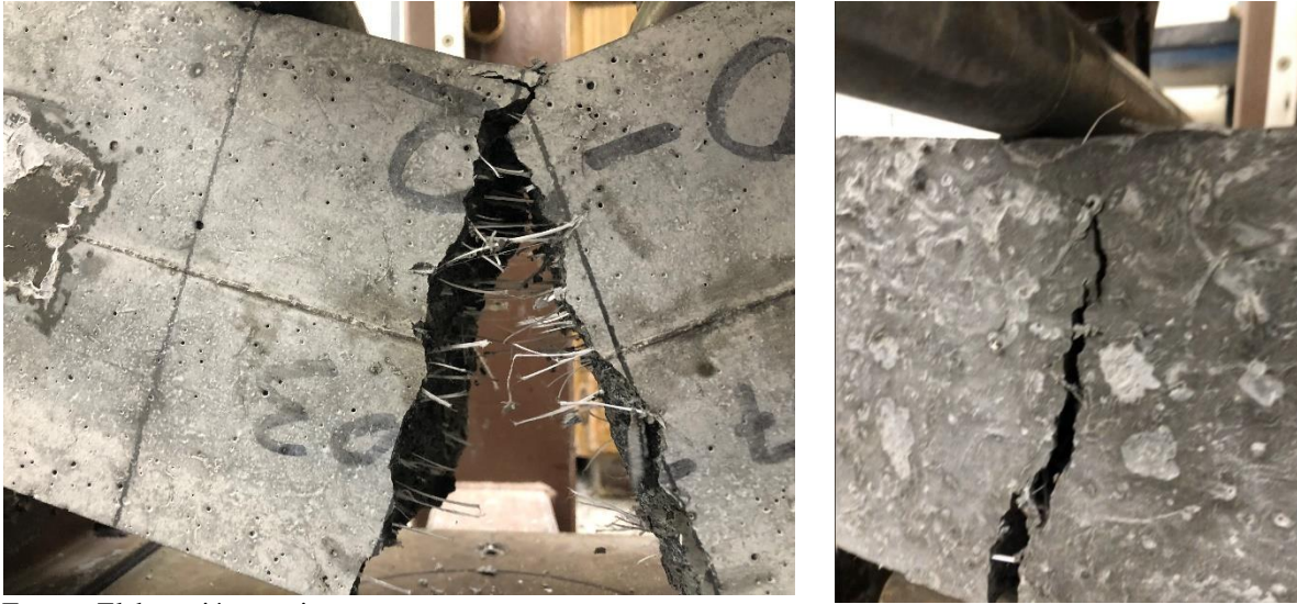
Fig. 7. Falla frágil y dúctil
