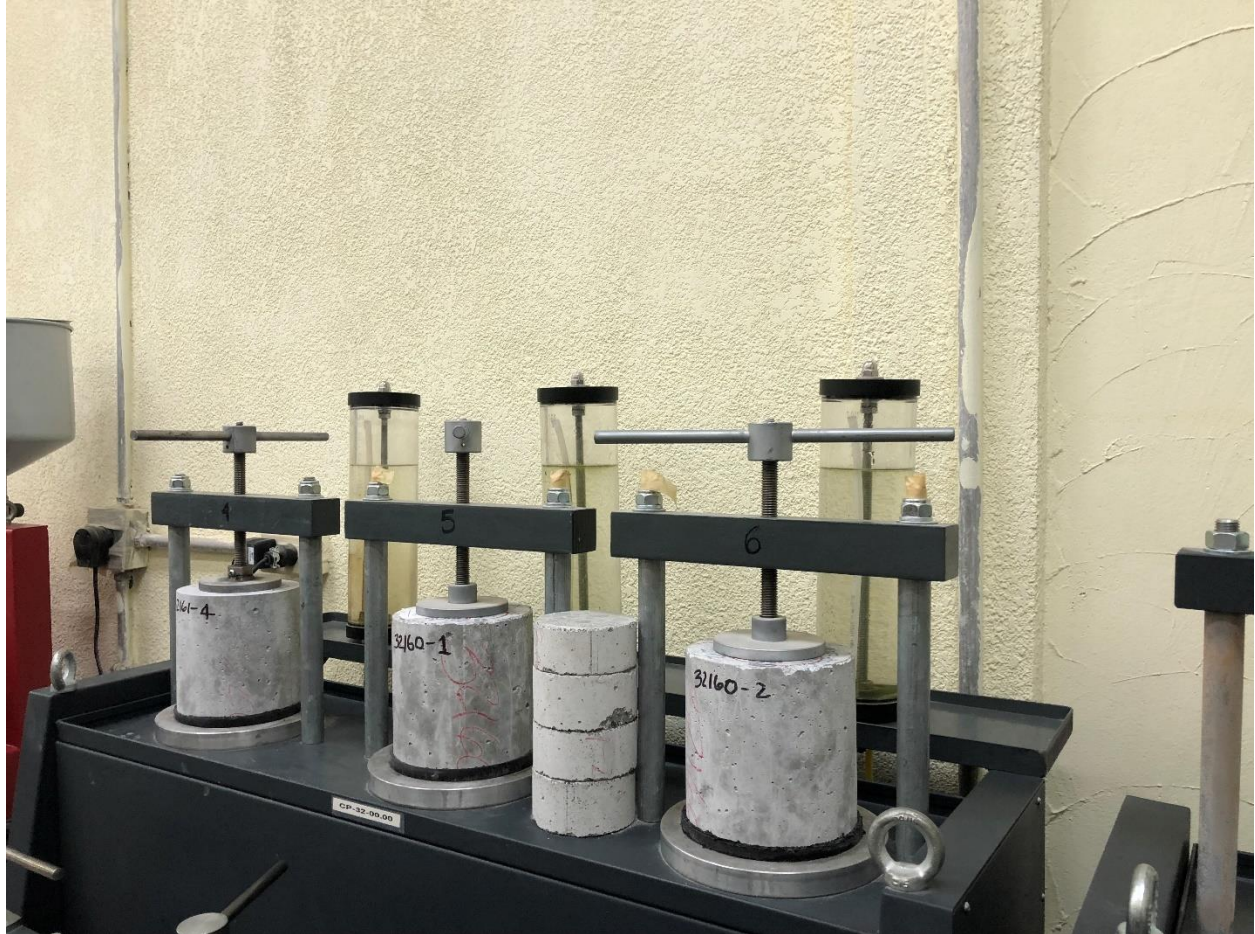
Fig. 53. Ensayo de penetración de agua
