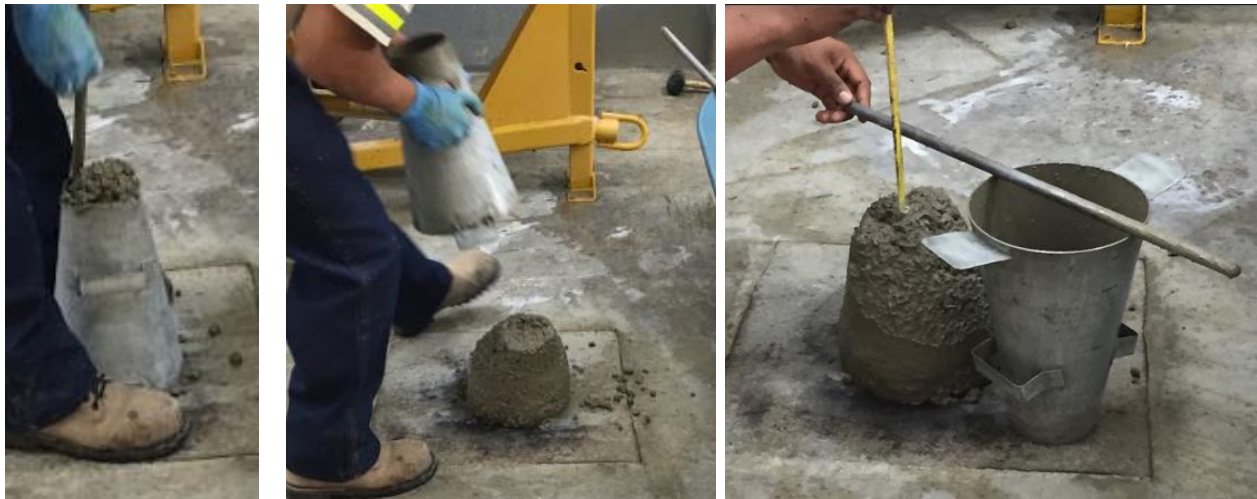
Fig. 12. Obtención del asentamiento
