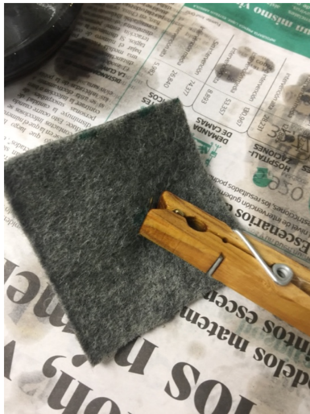
Ilustración 22. Adsorbente Ultra-X-Tex utilizado
