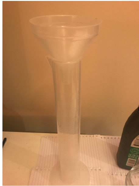
Ilustración 23. Sistema utilizado para medir la viscosidad del aceite de motor
