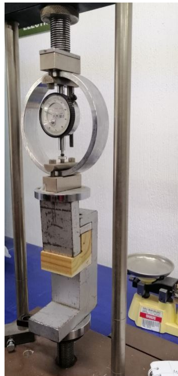
Figura 21: Montaje de prueba de corte
