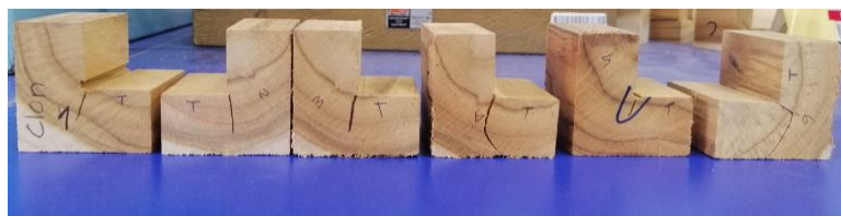
Figura 34: Falla prueba a corte cara tangencial Teca clonada
