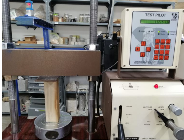
Figura 12: Montaje de prueba a compresión paralela al grano
