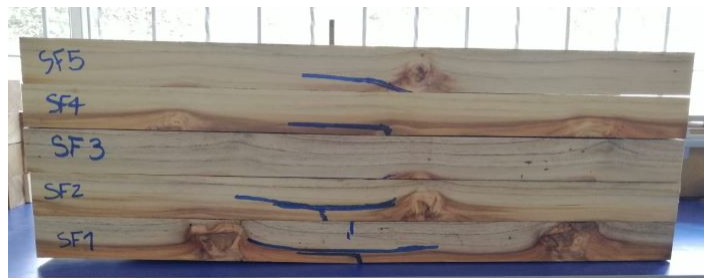
Figura 23: Falla prueba a flexión Teca natural muestras 1 a 5
