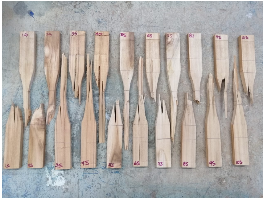
Figura 37: Falla prueba tracción paralela al grano de Teca natural vista frontal
