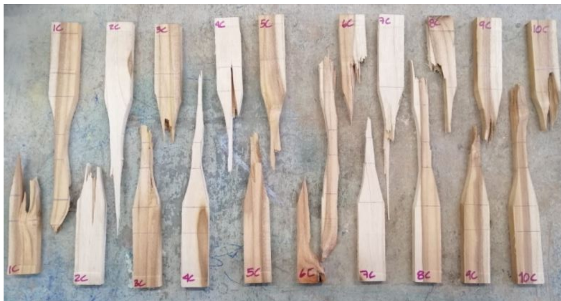
Figura 39: Falla prueba tracción paralela al grano de Teca clonada vista frontal
