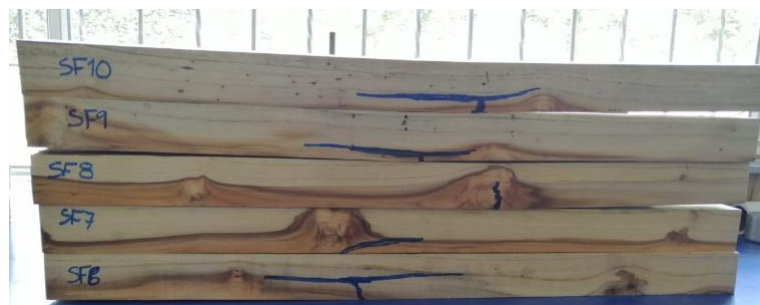
Figura 24: Falla prueba a flexión Teca natural muestras 6 a 10
