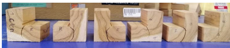
Figura 33: Falla prueba a corte cara radial Teca clonada
