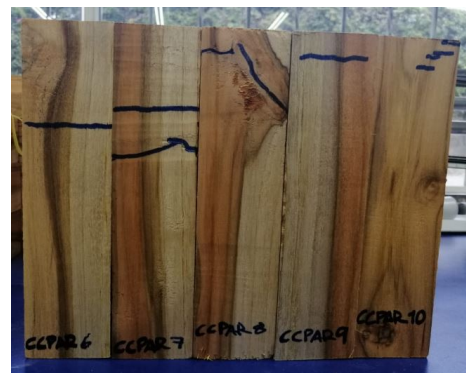
Figura 30: Falla prueba a compresión paralela Teca clonada muestras 6 a 10
