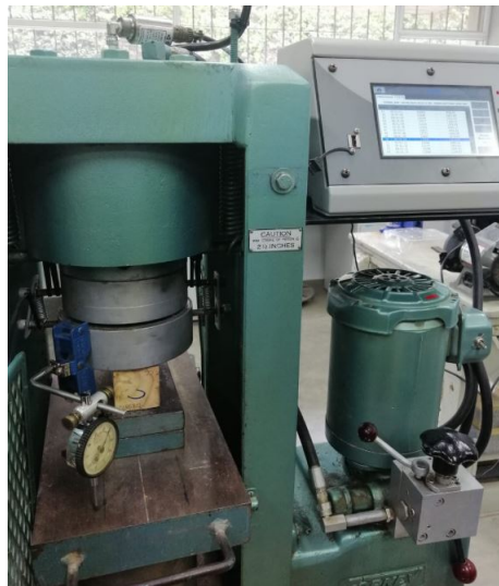
Figura 14: Montaje de prueba a compresión perpendicular al grano
