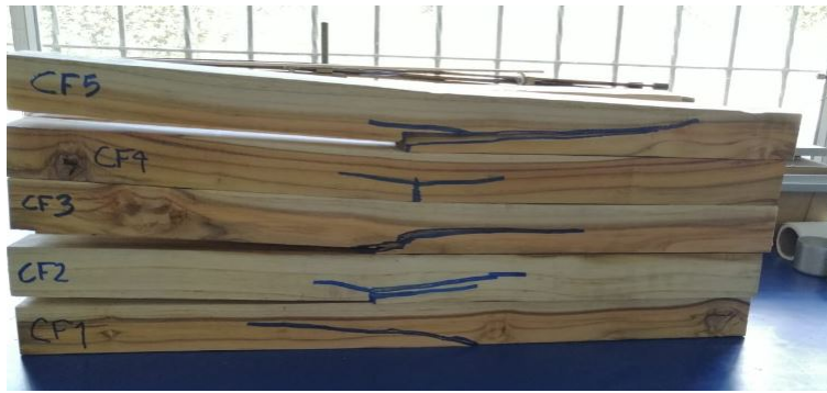
Figura 25: Falla prueba a flexión Teca clonada muestras 1 a 5
