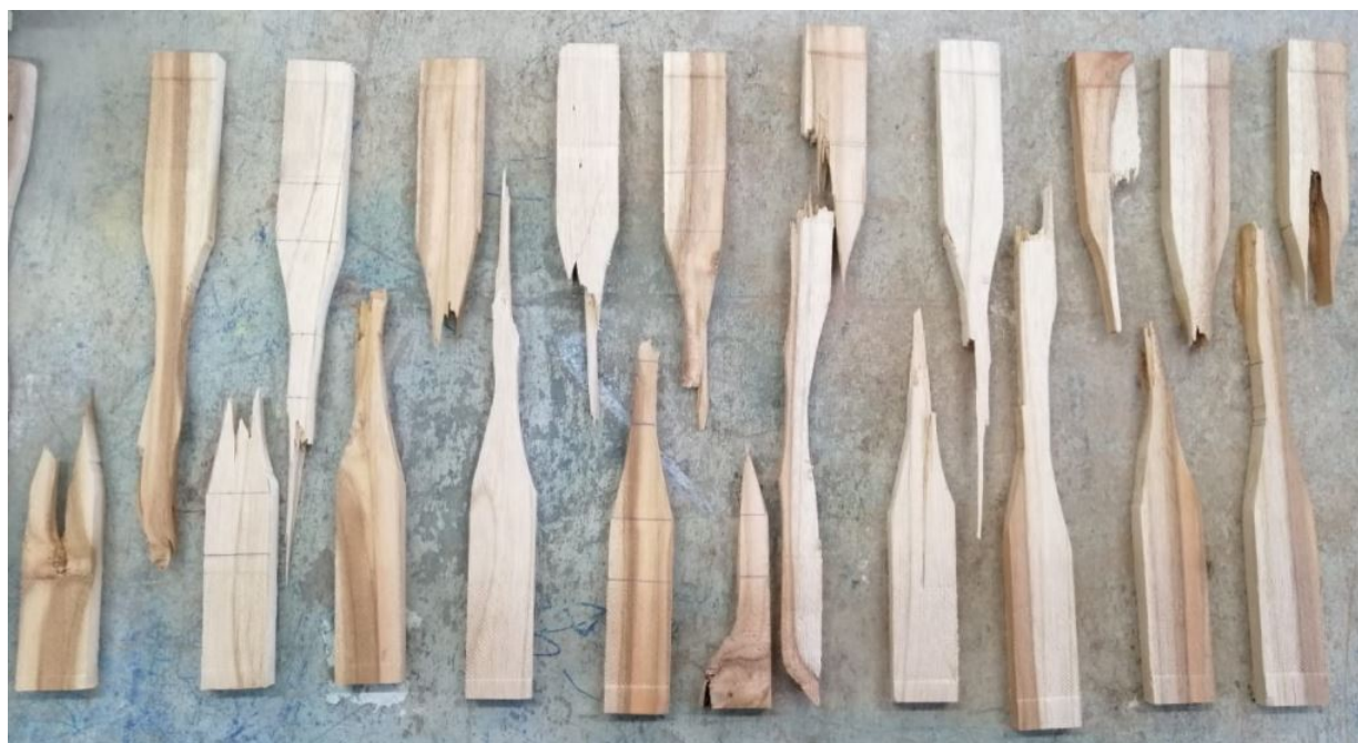
Figura 40: Falla prueba tracción paralela al grano de Teca clonada vista trasera
