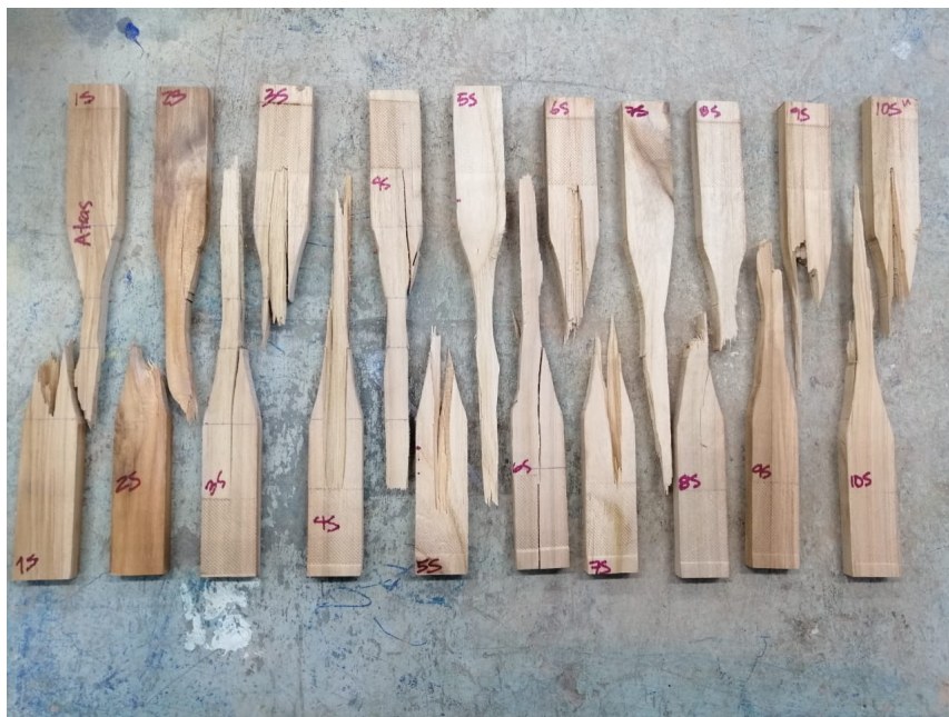
Figura 38: Falla prueba tracción paralela al grano de Teca natural vista trasera
