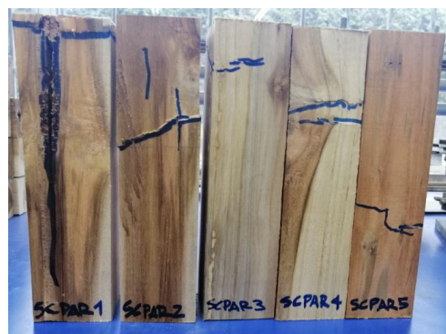
Figura 27: Falla prueba a compresión paralela Teca natural muestras 1 a 5
