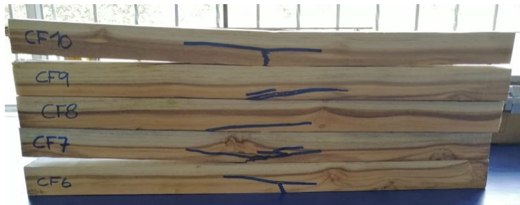
Figura 26: Falla prueba a flexión Teca clonada muestras 6 a 10
