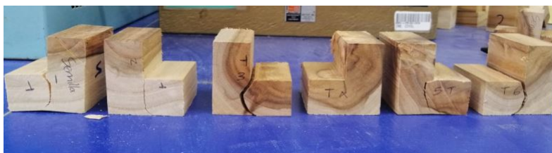
Figura 32: Falla prueba a corte cara tangencial Teca natural
