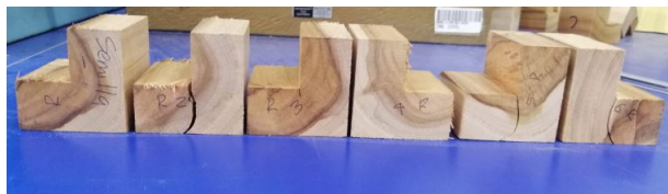
Figura 31: Falla prueba a corte cara radial Teca natural
