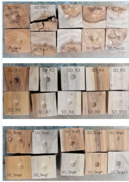
Figura 35: Falla prueba dureza en cara transversal, radial y tangencial de Teca natural
