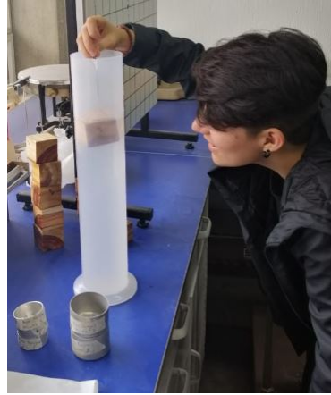
Figura 22: Montaje de prueba de densidad
