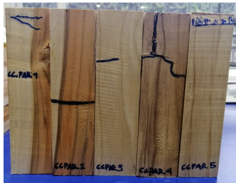
Figura 29: Falla prueba a compresión paralela Teca clonada muestras 1 a 5
