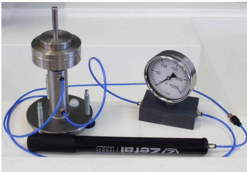
Figura 1. Calibración de manómetros usando pesos muertos
