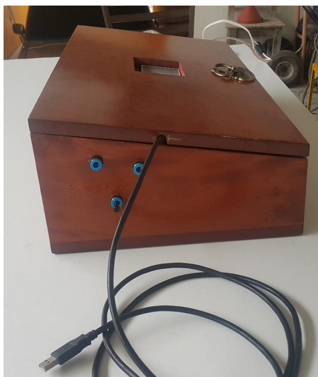
Anexo 7. Vista lateral del sistema de calibración de manómetros de presión diferencial
