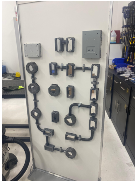
Figura 15. Sistema de tuberías del tablero
