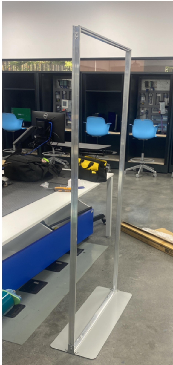
Figura 13. Base del tablero
