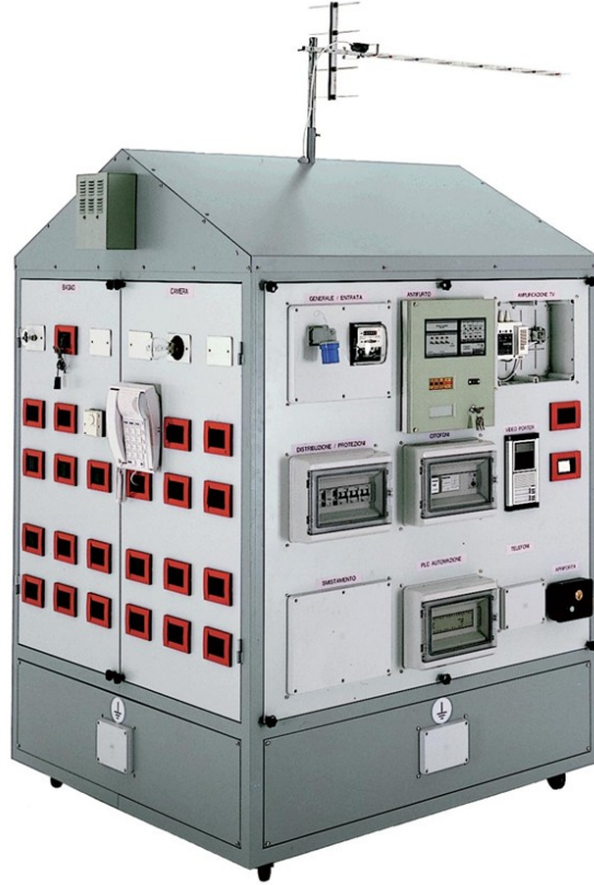
Nota. Casa didáctica para instalaciones y verificaciones eléctricas Mod. CD/EV de Elettronica Veneta
