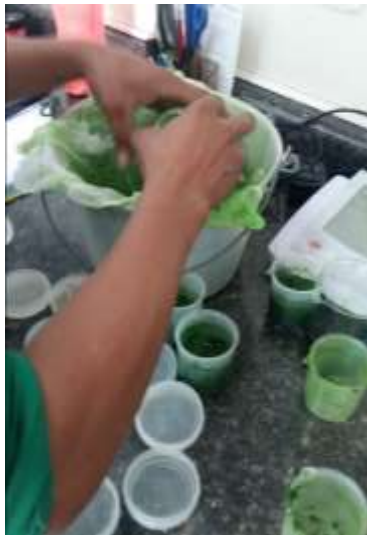
Figura 8: Filtrado de la mezcla utilizando una gasa. Fuente: Del Águila, Ch (2019)
