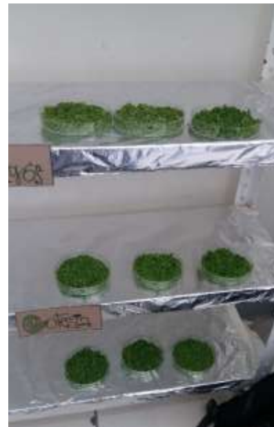
Figura 11: Muestras elaborados en reposó para eliminar posibles restos de etanol.
