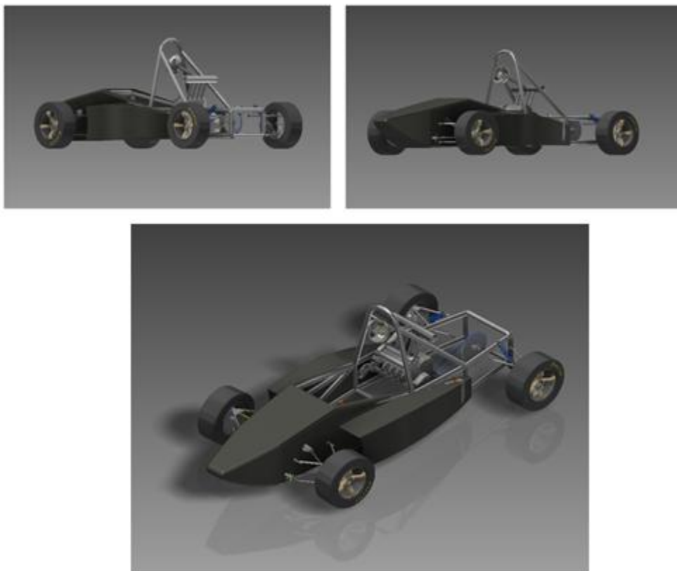
Figura 40. Carrocería instalada en chasis con componentes del vehículo.
