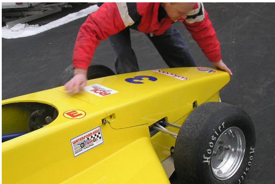
Figura 23. Instalación de sección en la parte frontal utilizando Toggle Latch Fasteners.
