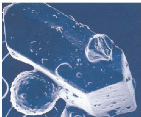
Microesfera de vitamina A adherida a un cristal de azúcar
