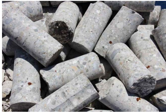
Figura 7. Testigos de concreto
