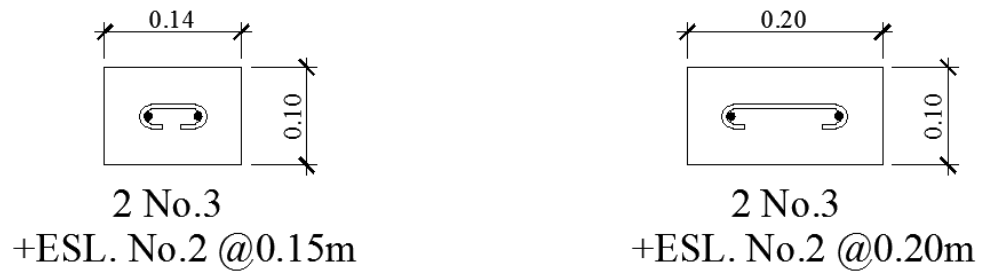
lustración 87: Detalles de sillares en ventanas
