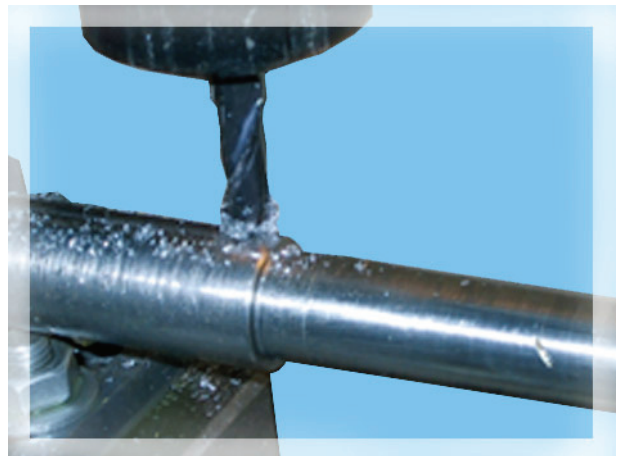
Fotografía 16. Aplanado de canto de barra con fresa de 5/16".
