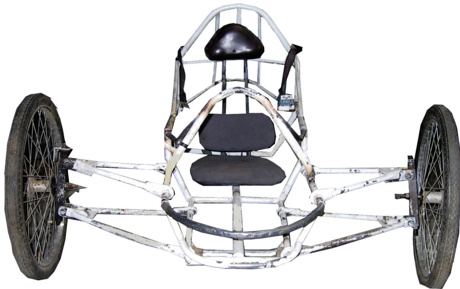
Fotografía 7. Vista de los brazos transversales desiguales.
