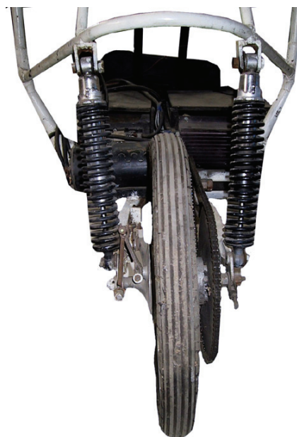
Fotografía 9. Suspensión trasera. Vista trasera.
