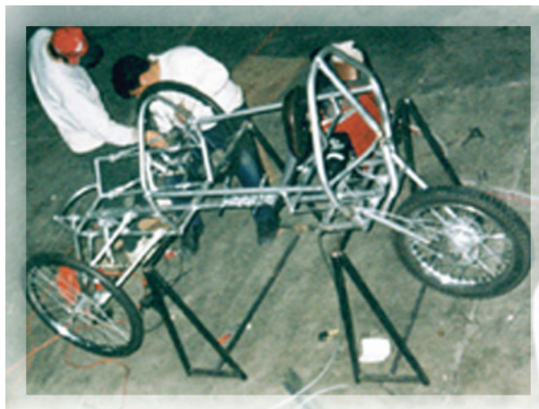
Fotografía 10. Construyendo el chasis preliminar
