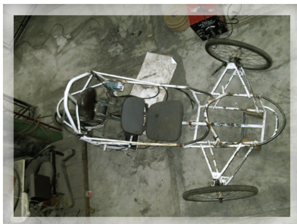
Fotografía 21. Vista aérea del chasis final
