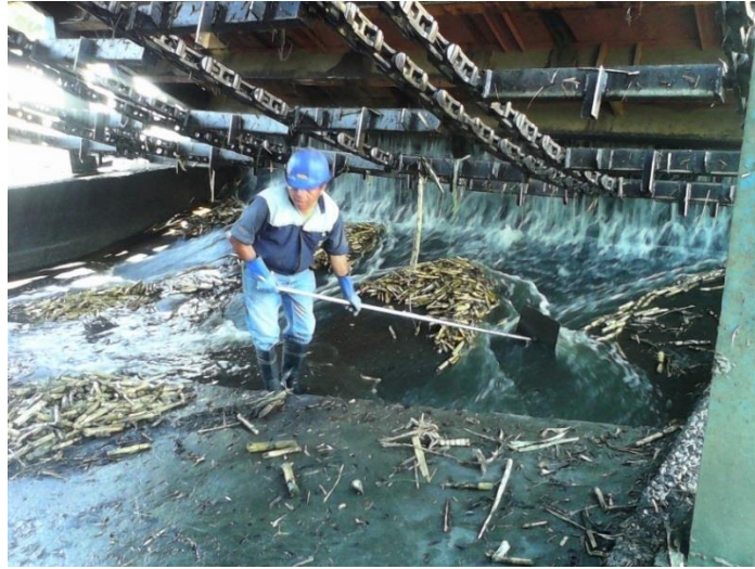
Figura 93. Criba de salida del efluente de las mesas de lavado de caña
