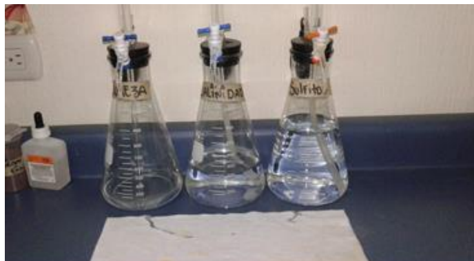
Figura 106. Cristalería utilizada para mediciones de concentraciones de compuestos químicos disueltos en aguas residuales del laboratorio de control de calidad del Ingenio Tzululá S.A.
