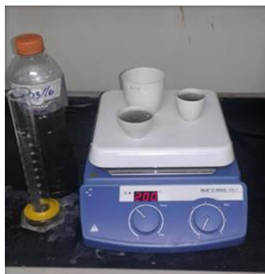
Figura 105. Estufa eléctrica y crisoles para determinación de sólidos totales del laboratorio de análisis instrumental de la Universidad del Valle
