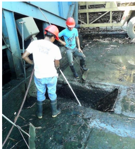
Figura 94. Limpieza manual de las cribas
