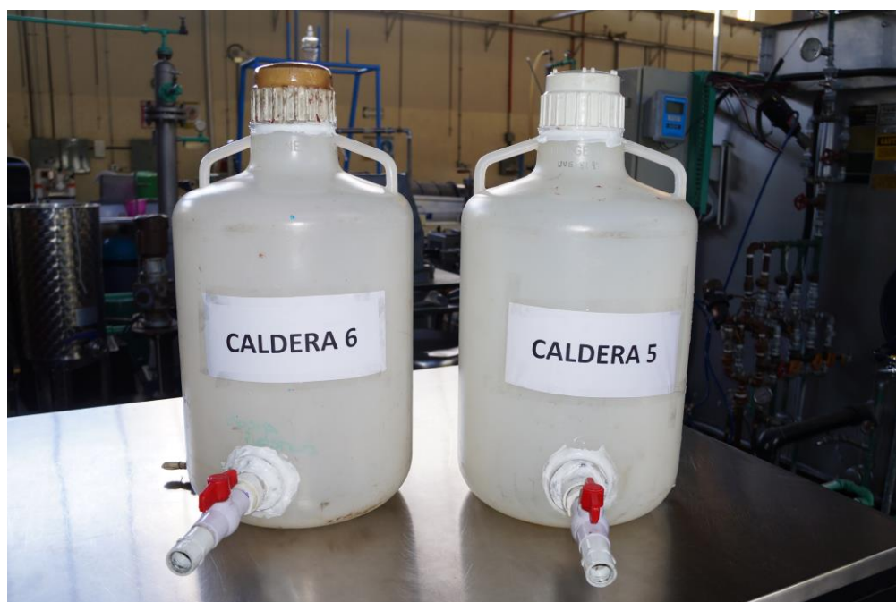
Figura 33. Recipientes contruidos para almacenamiento de gases de combustión.
