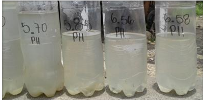
Figura 110. Mejores resultados obtenidos con la planta de tratamiento de aguas residuales en operación
