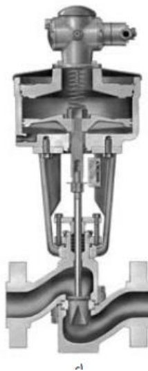
Figura 13. Válvula de control con activador neumático
