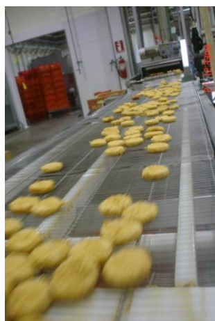
Fig. 9. Banda transportadora entre freidora e IQF
