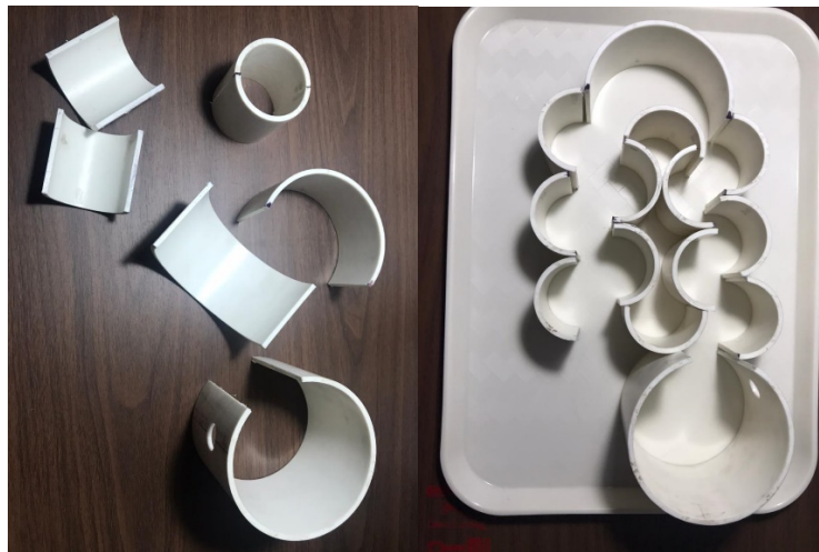
Figura no. 19 “Cortes de tubería PVC y ensamble de gotero didáctico”
