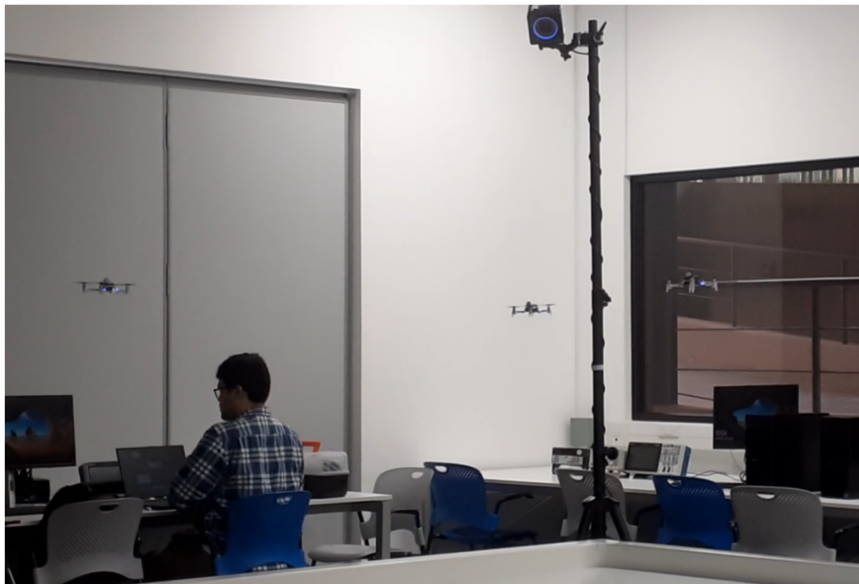
Figura 3. Prueba de vuelo con tres drones utilizando el software CrazySwarm 2 [6].
