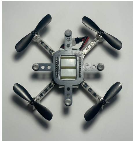
Figura 31. Versión final de marcador reflectivo para dron Crazyflie.
