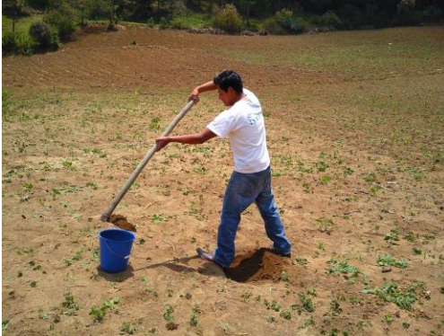
Figura128. Mezclado de varias tomas de suelo para crear una mezcla homogénea y representativa del terreno.
