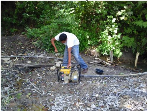
Figura130. Bomba de agua a base de combustión que es utilizada para extraer el agua de riego.
