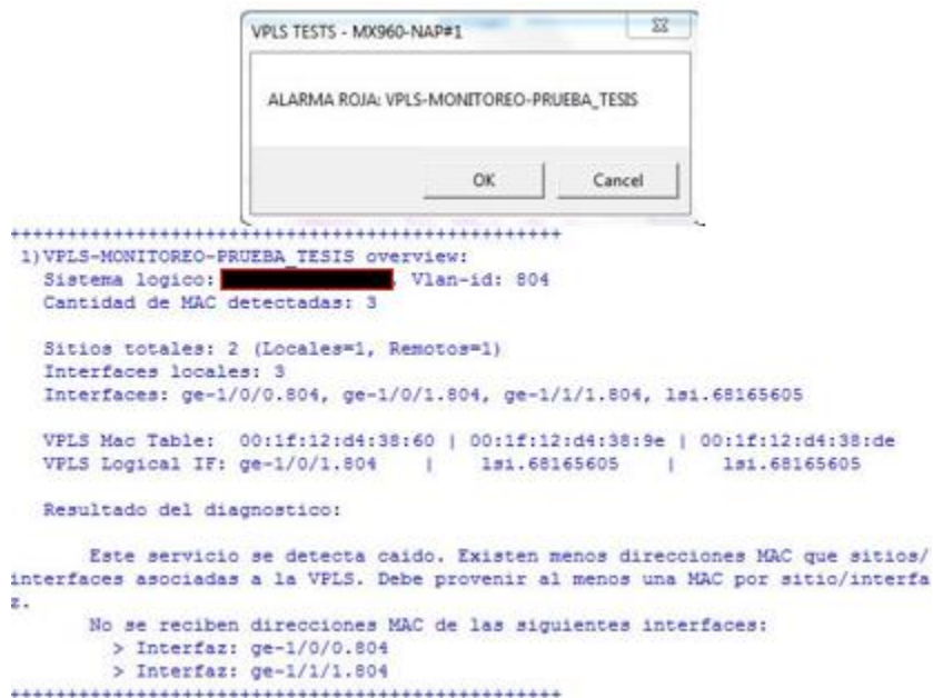
Figura#209: Pruebas técnicas sobre VPLS configurada: Escenario 7, NAP1 previo
