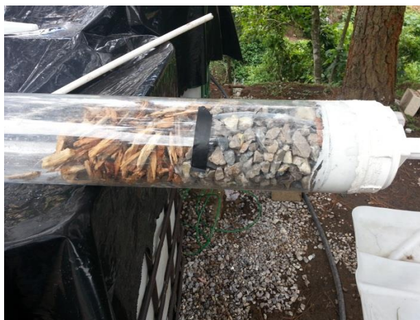
Ilustración 38: Llenado del biofiltro con las ramas de ficus trituradas.
