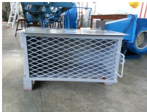
Ilustración 32: Caja metálica de 70x35x30 cm para colocación de contactor, selector de tres posiciones, botón Start/Stop, bomba dosificadora y bomba de aire.
