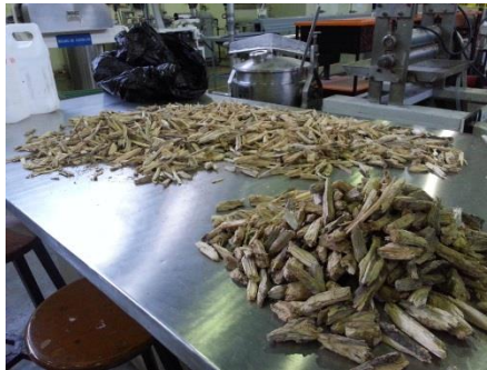
Ilustración 22: Selección manual del material filtrante a partir de ramas de ficus trituradas.
