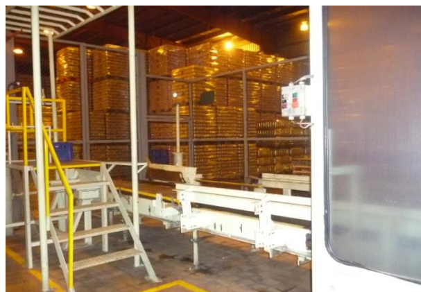
Figura 45. Inicio de la banda del transporte de palé del salón de embotellado #3.
