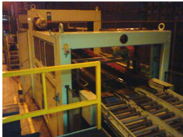
Figura 47. Bandas de la máquina despaletizadora del transporte de palé del salón de embotellado #3.
