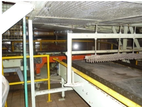
Figura 48. Primer inversor. Vista desde el transportador que recibirá el palé que envía el primer inversor
