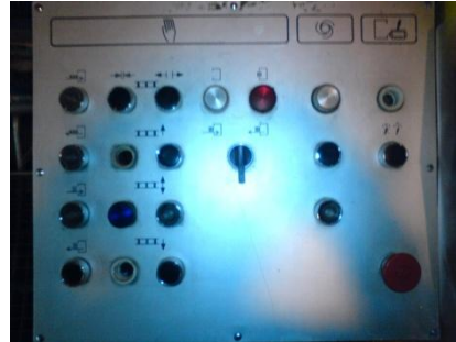
Figura 54. Teclado para manejar el almacén de palé del transporte de palé del salón de embotellado #3
