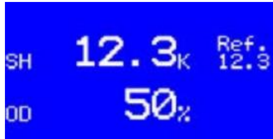
Figura 46. Pantalla de control de sobrecalentamiento de la interfaz Danfoss MMIMYK [7]
