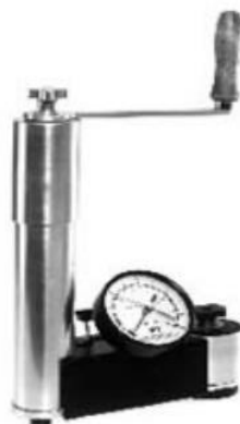
Figura No. 110 Instrumentación para prueba de extracción.
