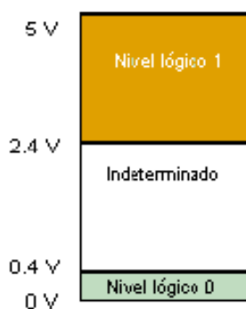
Figura No. 172. Rango de niveles lógicos en tecnología TTL.
