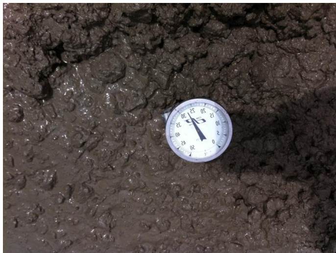
Figura No. 255. Registro manual de temperatura del concreto fresco.
