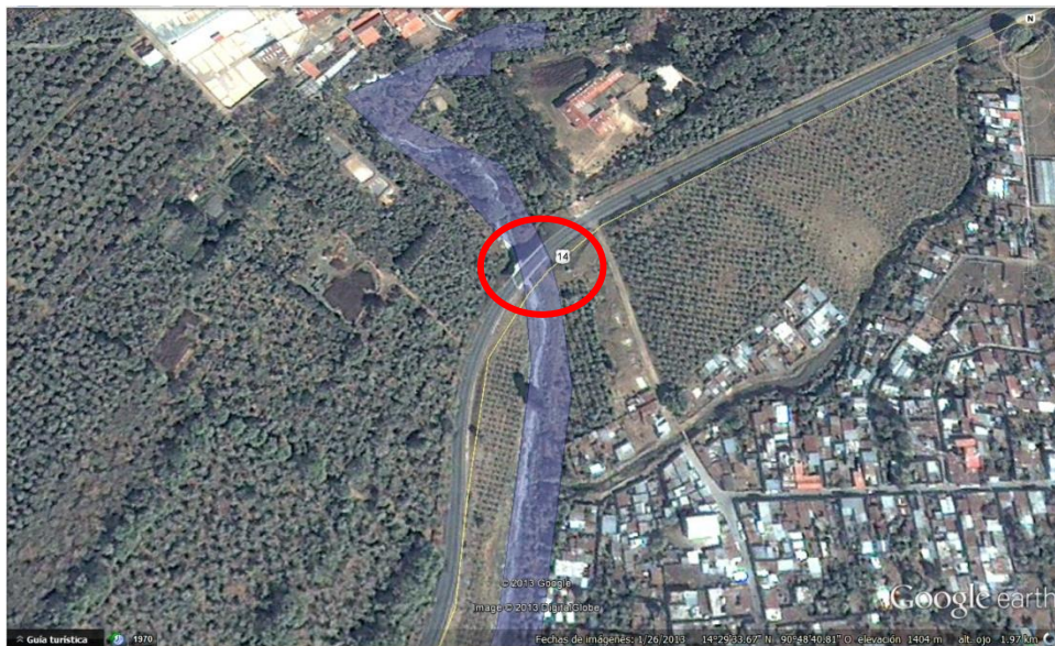
Figura No. 215. Área de inundación en Alotenango generada por una crecida con período de retorno de dos años.
