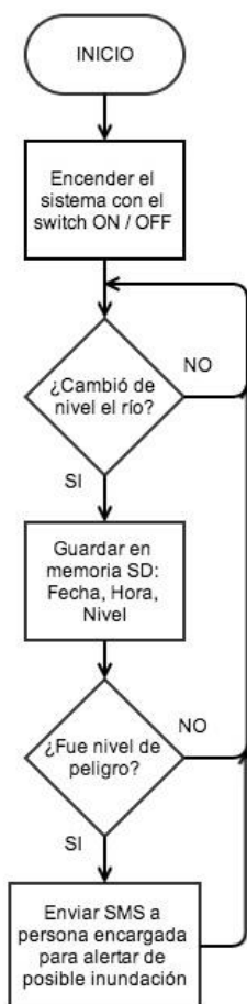
Diagrama de flujo de funcionamiento sensor de nivel.
