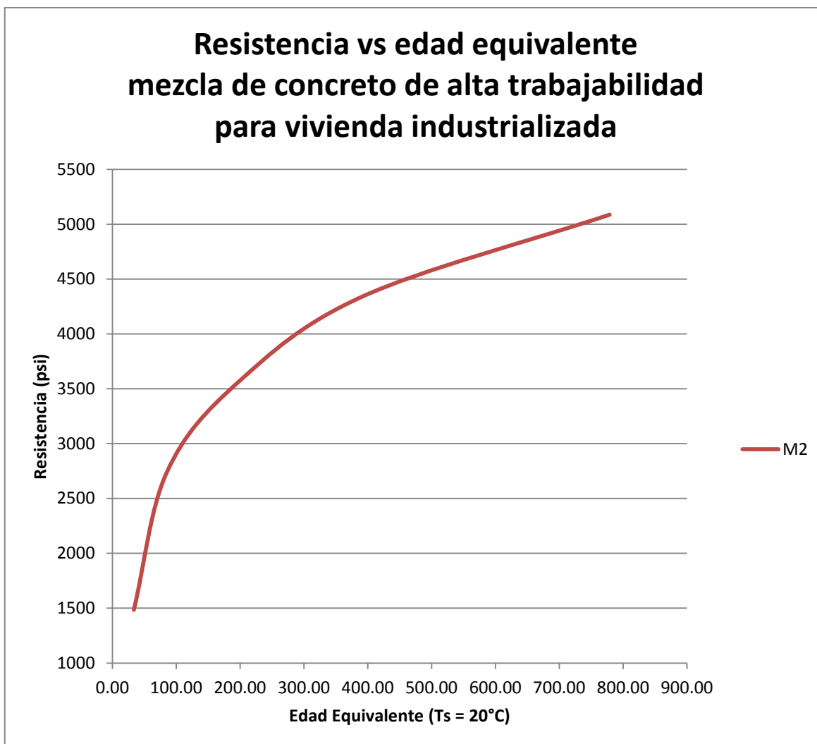
Figura No. 131 Curva de calibración de concreto de alta trabajabilidad para vivienda industrializada utilizando edad equivalente como índice de madurez.
