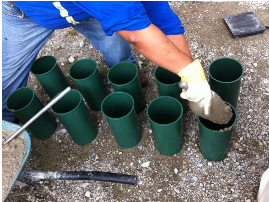
Figura No. 256. Fabricación de moldes cilíndricos de concreto.
