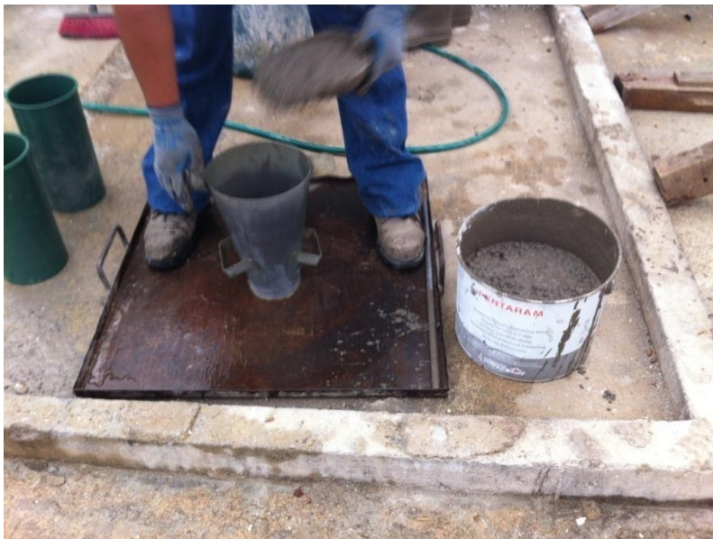
Figura No. 257. Prueba de Flujo del concreto.
