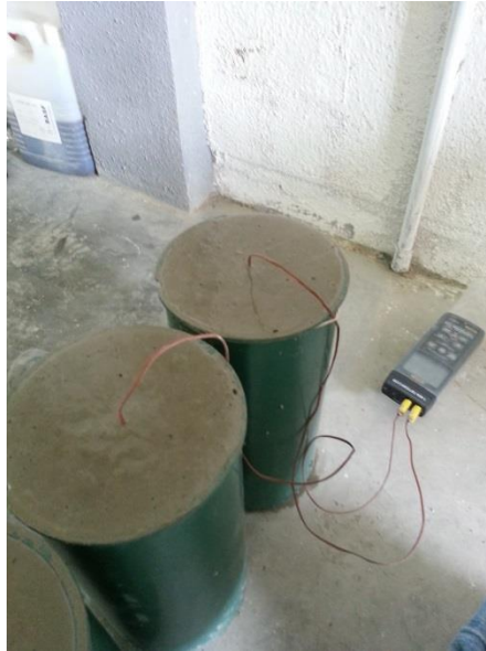
Figura No. 248. Datalogger y termocuplas insertadas en cilindros.
