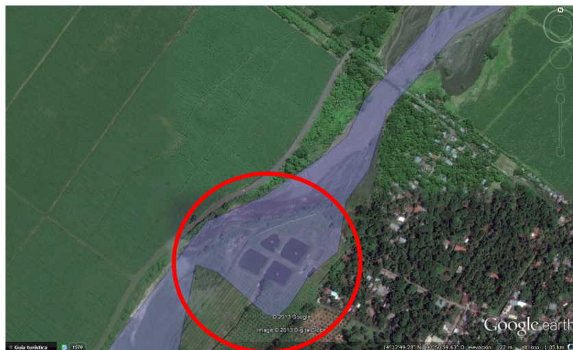
Figura No. 221. Área de inundación en Masagua generada por una crecida con período de retorno de dos años.
