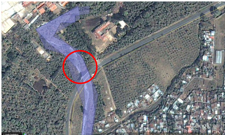
Figura No. 218. Área de inundación en Alotenango generada por una crecida con período de retorno de 100 años.
