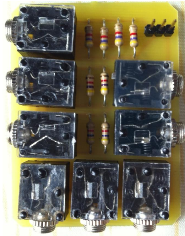
Figura No. 245 Placa de entradas sensor de temperatura terminada.
