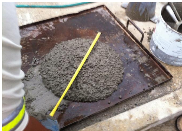
Figura No. 136 Prueba de flujo en el concreto.
