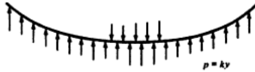
Figura No. 26 Esquema estimado de deflexión de una losa de pavimentación cargada.
