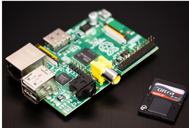
Figura No. 37 Raspberry PI modelo B.
