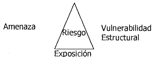
Gráfica 3. Triángulo de riesgo reducido al aminorar la exposición con una adecuada localización
