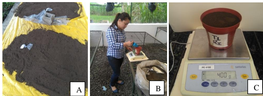
A) Secado de suelo al aire libre B y C) Llenado de macetas con 400g de suelo y pesado en una balanza digital
